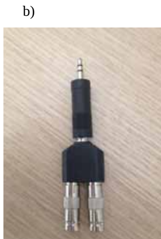
Figura 4.3 – (a) Condicionador de Sinais de Sensores do tipo ICP, (b) adaptador do tipo P2 para BNC e (c) fixação do acelerômetro ICP na membrana acústica da caixa de som.
