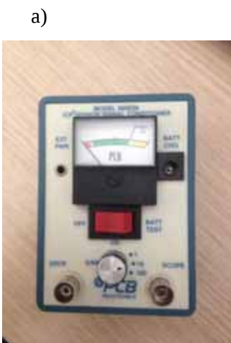
Figura 4.3 – (a) Condicionador de Sinais de Sensores do tipo ICP, (b) adaptador do tipo P2 para BNC e (c) fixação do acelerômetro ICP na membrana acústica da caixa de som.
