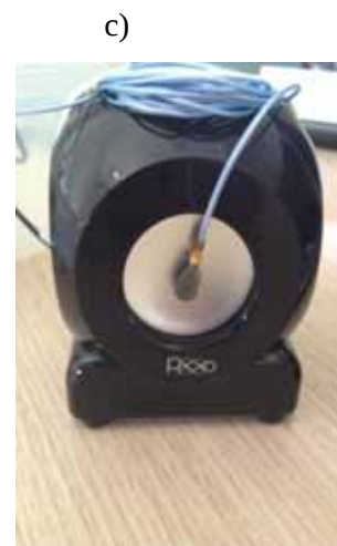
Figura 4.3 – (a) Condicionador de Sinais de Sensores do tipo ICP, (b) adaptador do tipo P2 para BNC e (c) fixação do acelerômetro ICP na membrana acústica da caixa de som.
