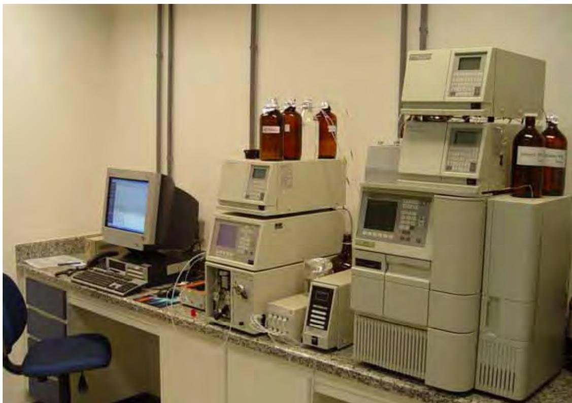
Figura 2: Ilustração fotográfica de um cromatógrafo: composto pela bomba, coluna cromatográfica, detector e o registrador.
