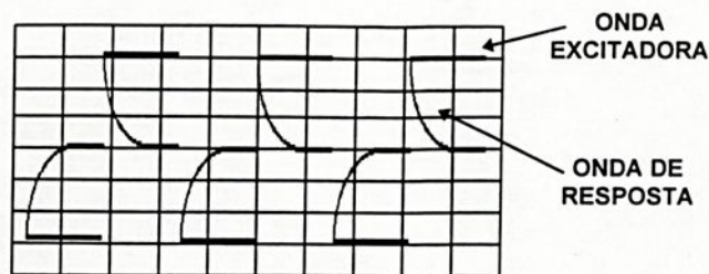
Figura 51- Forma representativa de onda quadrada utilizada nos sistemas de implementação do sensor.
