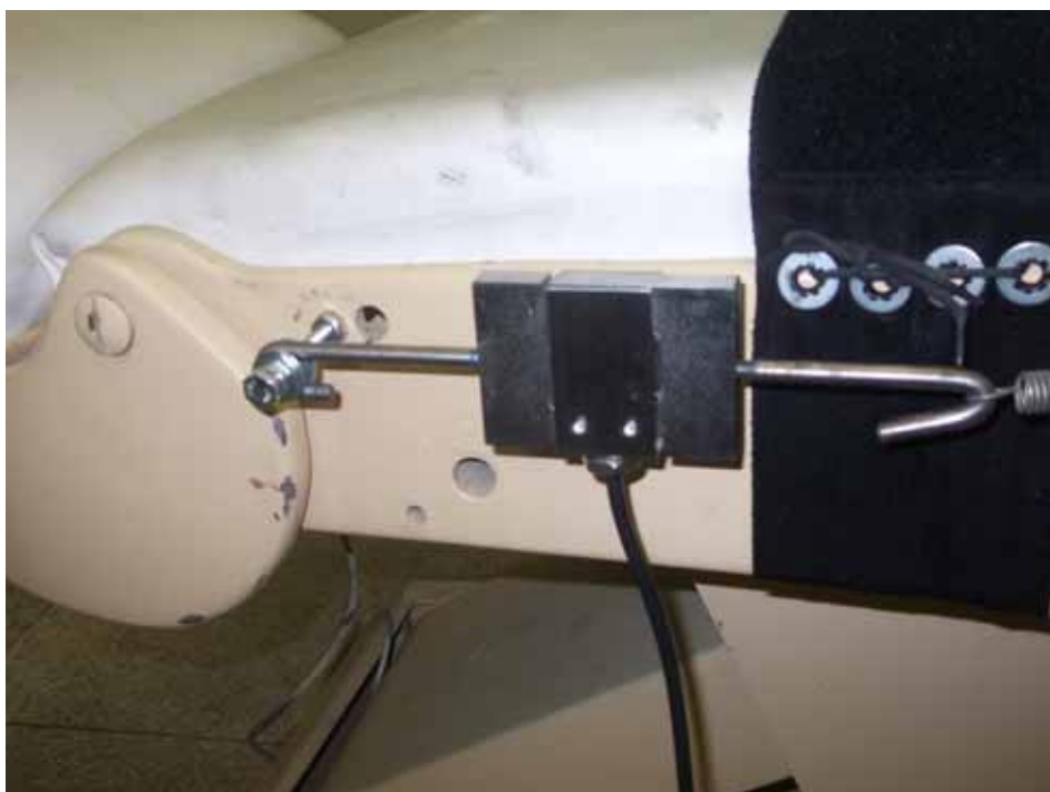
Figura 13- Célula de carga, montada na maca.
