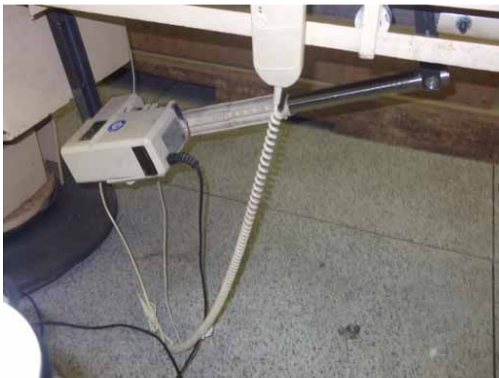
Figura 10- Detalhe do motor hidráulico que realiza a tração.
