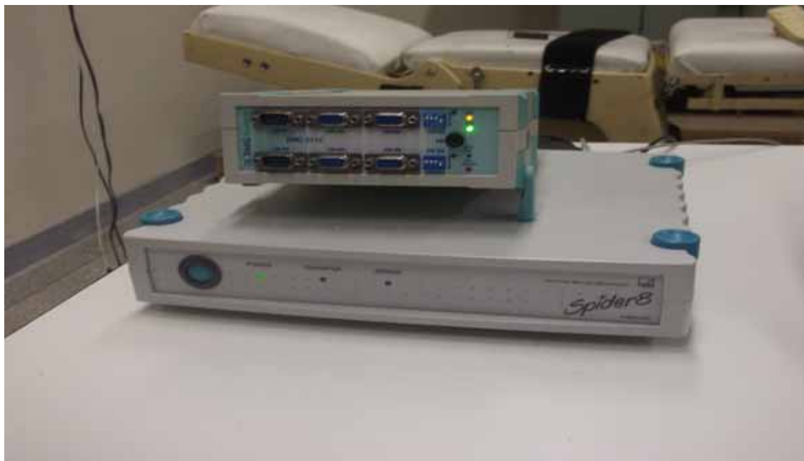
Figura 14- Equipamento Spider 8, montado com eletromiógrafo.
