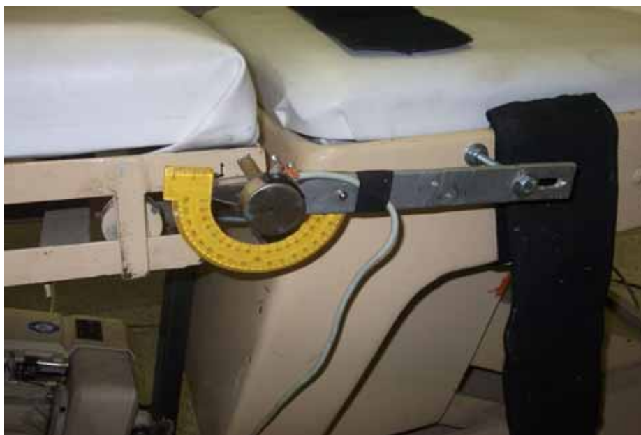
Figura 12- Goniômetro digital elaborado através de um potenciômetro
