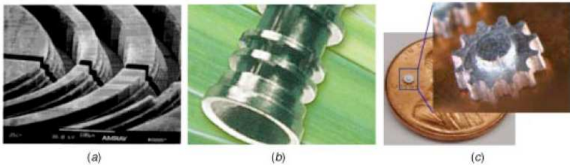
Figura 3 - (a) Canais microfresados com paredes em degrau, (b) componente neurovascular, e (c) microengrenagem.
