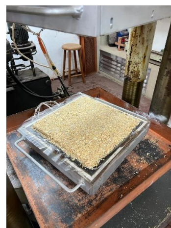
(c) Painel de partículas após prensagem.
