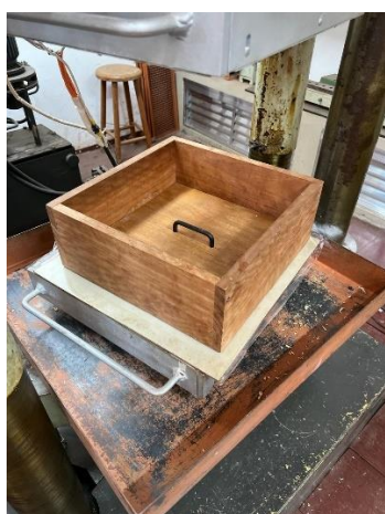
(a) Formadora com colchão de partículas em seu interior.
