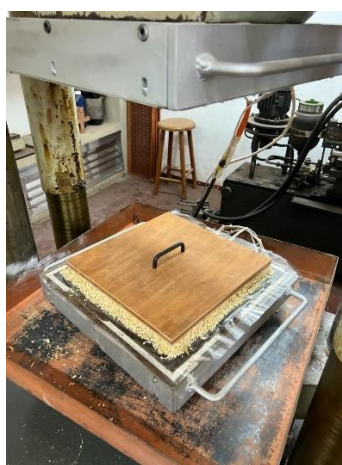
(b) Colchão de partículas após remoção da formadora de colchão.
