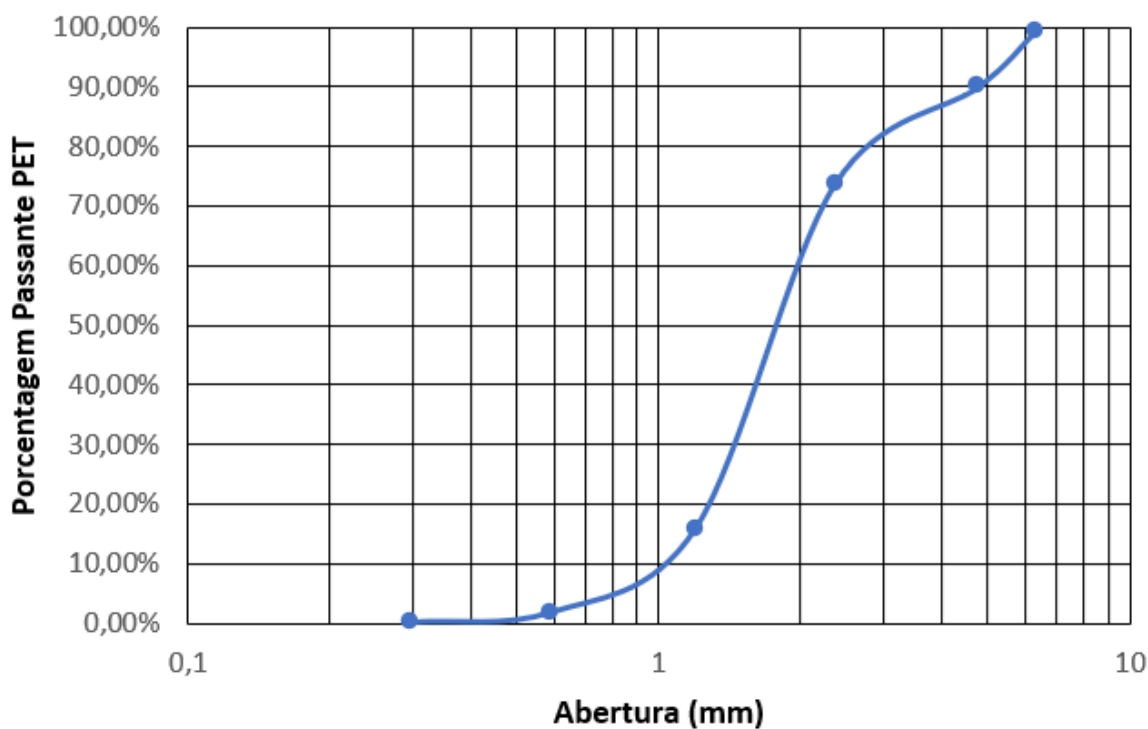
Figura 20 – Curva "S" para composição granulométrica do PET
