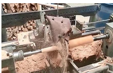
(b) Torneamento da peça e geração de maravalha.
