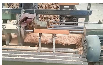
(a) Caibro fixado no dispositivo
