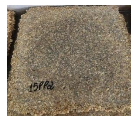
(c) Painél de partículas após prensagem
