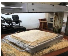
(b) Colchão de partículas pronto para prensagem na prensa aquecida.
