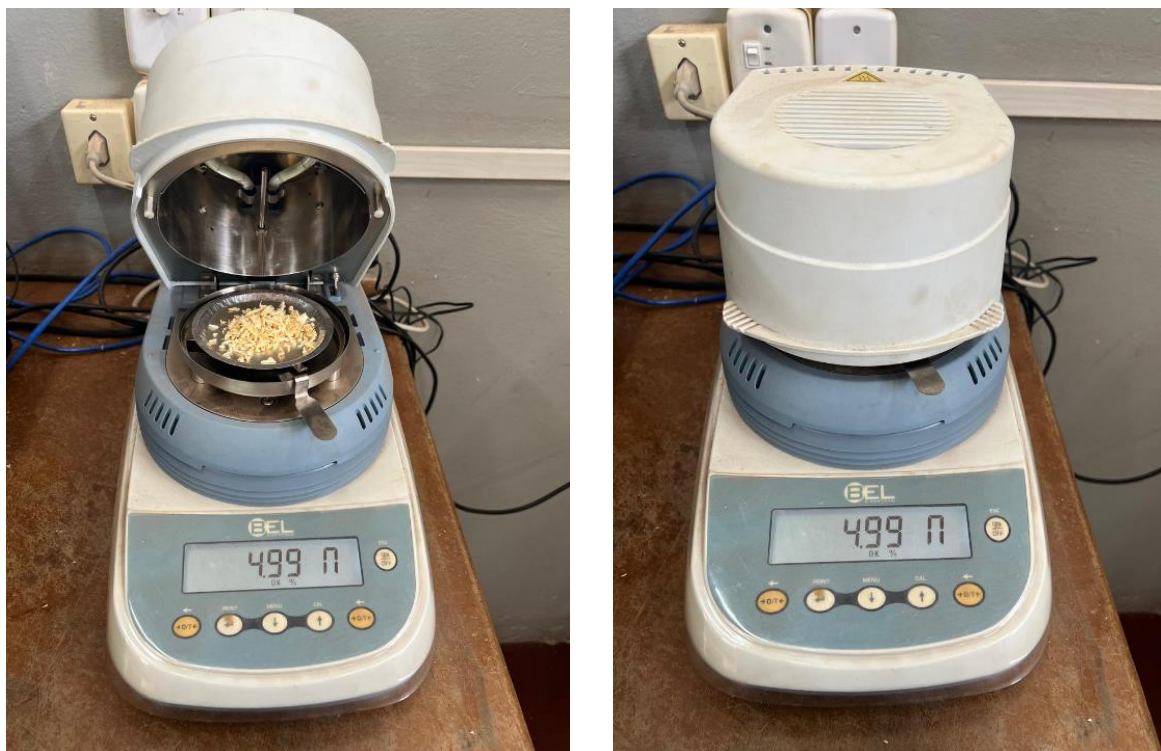
Figura 13 – Balança térmica para determinação do teor de umidade das partículas
