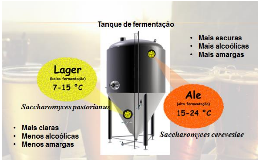
Figura 9- Ilustração dos dois tipos mais comuns de fermentação de cerveja: ale e lager
