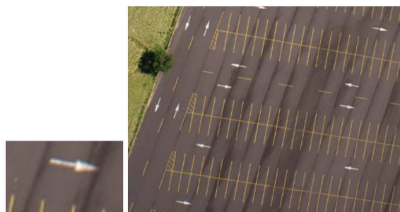
Figura 18. Problema de ambiguidade no processo de correspondência causado pela presença de padrões repetitivos (em destaque) na imagem.
