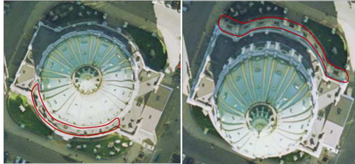
Figura 17. Problema de oclusão no processo de correspondência: feições só aparecem em uma das imagens devido à variação de perspectiva (destaque).
