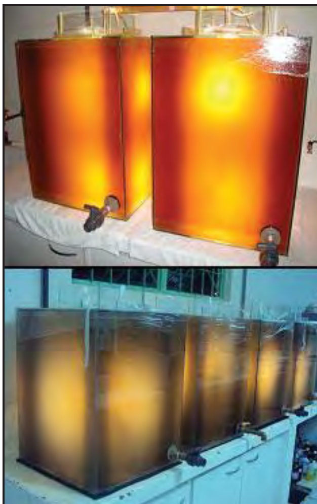
FIGURA 6 - Reatores biológicos utilizados para o cultivo do micro-organismo no efluente de indústria de processamento de pescado.
