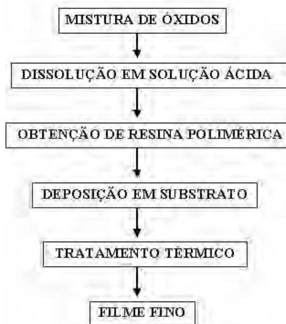
Figura 11: Fluxograma para produção de filmes finos ferroelétricos a partir de óxidos 11 .
