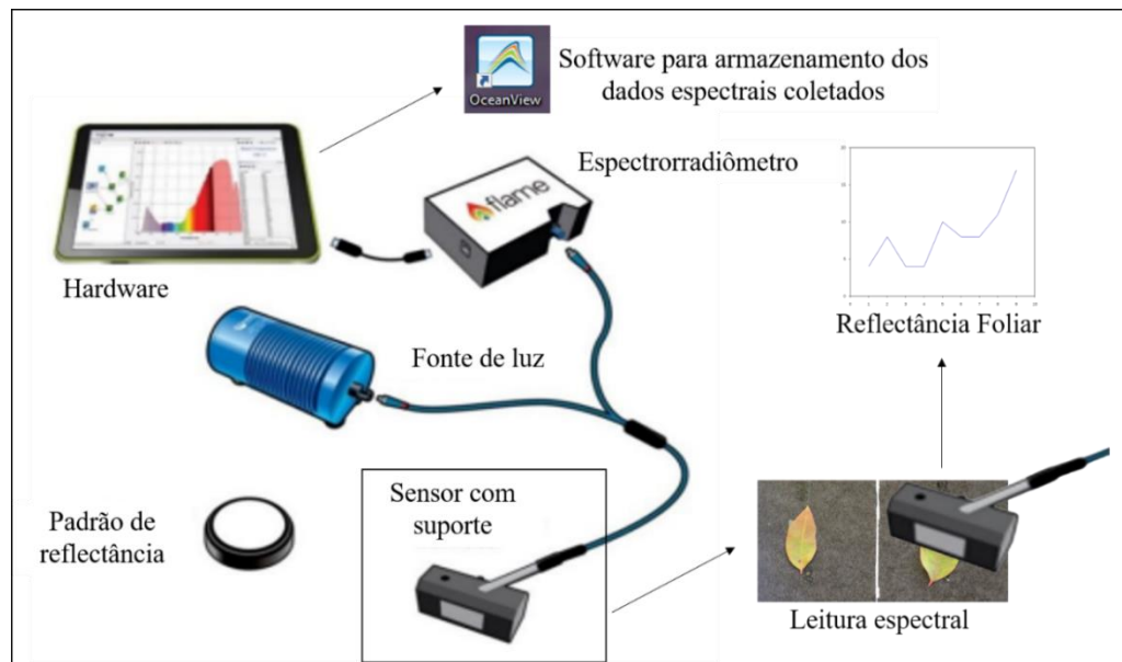
Figura 11 - Sistema dos procedimentos para a obtenção das reflectâncias foliares das mudas de Eucalyptus urophylla (clone I144) com o Espectrorradiômetro da Ocean Optics, modelo flame – NIR
