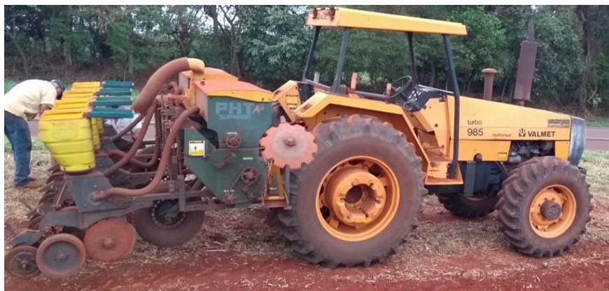
Figura 5. Semeadora PHT A3 Suprema, marca TATU (plantio direto)
