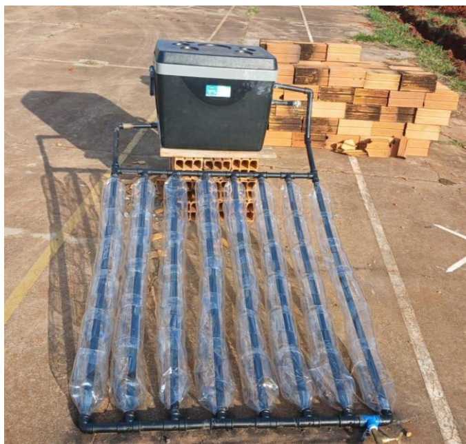
Figura 5- Coletor montado com as garrafas PET.
