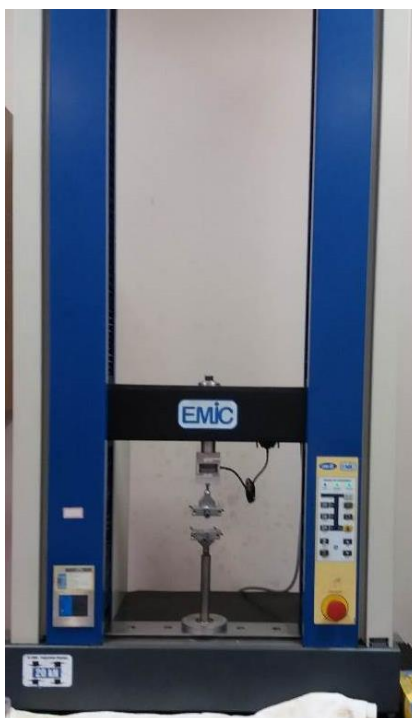
Figura 5. Imagem fotográfica da máquina universal de ensaios biomecânicos (EMIC® DL 2000) utilizada para o teste de tração das amostras de pericárdio bovino fresco visando a prática da cirurgia veterinária. Equipamento pertencente ao Laboratório de Anatomia Cirúrgica do Departamento de Morfologia e Fisiologia Animal da FCAV – UNESP – Jaboticabal.
