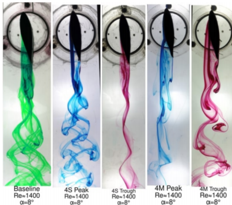
Figura 19 – Visualização experimental para 1400 Re e ângulo de ataque de 8^\circ .
