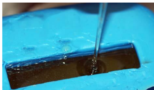
Fig 16. Vazamento da resina fotoelástica
