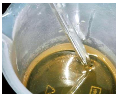
Fig 15. Manipulação da resina fotoelástica
