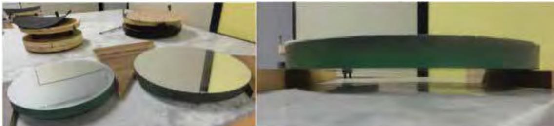
Figura 41 – Espelhos apoiados apenas por dois pontos em sua borda, para determinar as deformações causadas pelo seu próprio peso.
