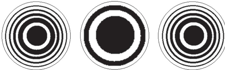
Figura 29 – Centro de interferometria de um espelho quase esférico antes do ponto focal, no ponto focal e após o ponto focal.
