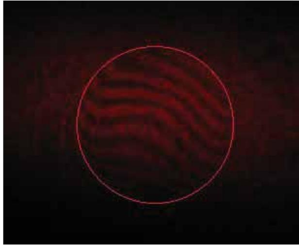
Figura 25 – Somatória dos feixes gerando as franjas de interferometria.
