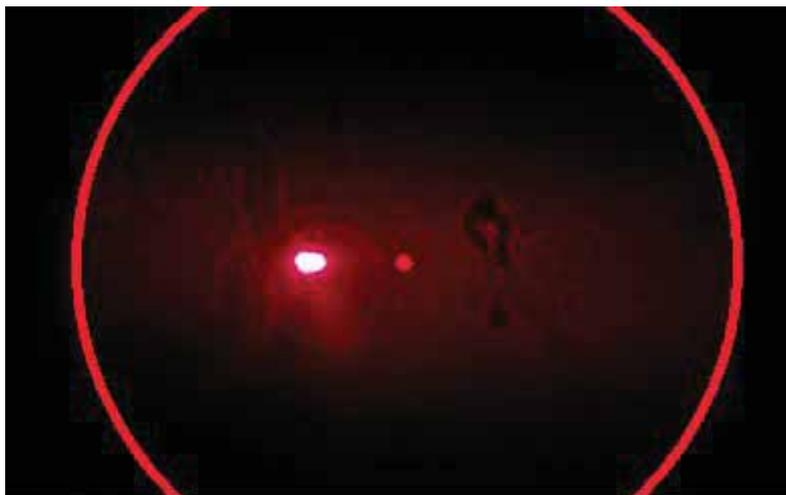
Figura 23 – Alinhamento da frente de onda esférica criada por L e o feixe de referência.
