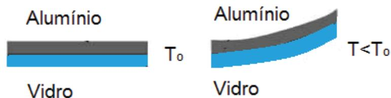
Figura 4 – Efeitos da diferença de dilatação térmica entre o vidro e o alumínio
