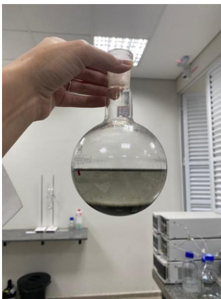
Figura 20. Processo de lavagem do óxido de grafeno magnetizado (OGM), com o auxílio de um ímã.
