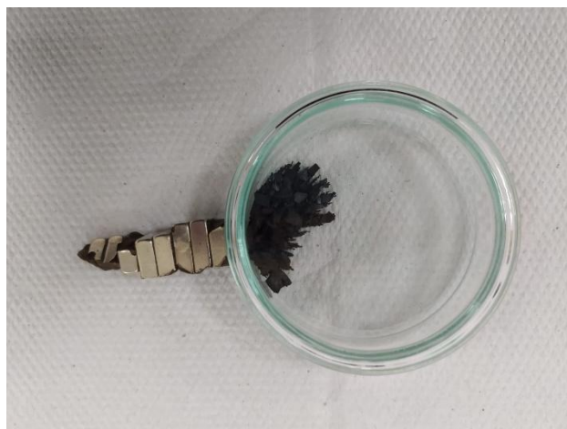
Figura 21. Óxido de Grafeno Magnetizado (OGM) sendo atraído por um ímã.
