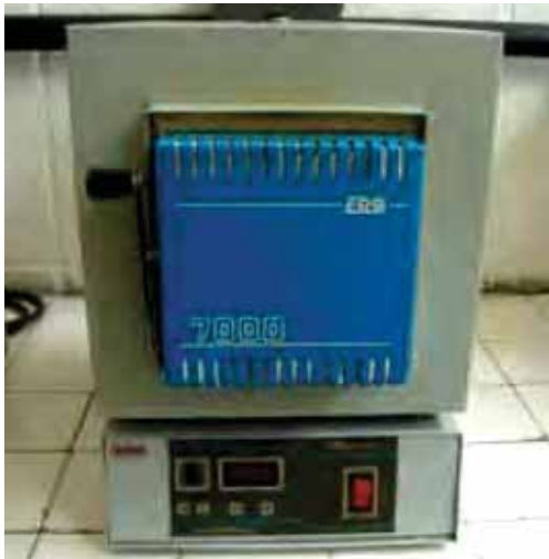
Figura 3.10 – Forno tipo mufla, utilizado durante os ensaios de impacto. (UNESP Campus de Guaratinguetá, 2011).
