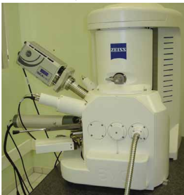
Figura 3.11 - Microscópio Eletrônico de Varredura (MEV), modelo ZEISS EVO LS 15 utilizado durante as análises. (UNESP – Campus de Guaratinguetá, 2011).
