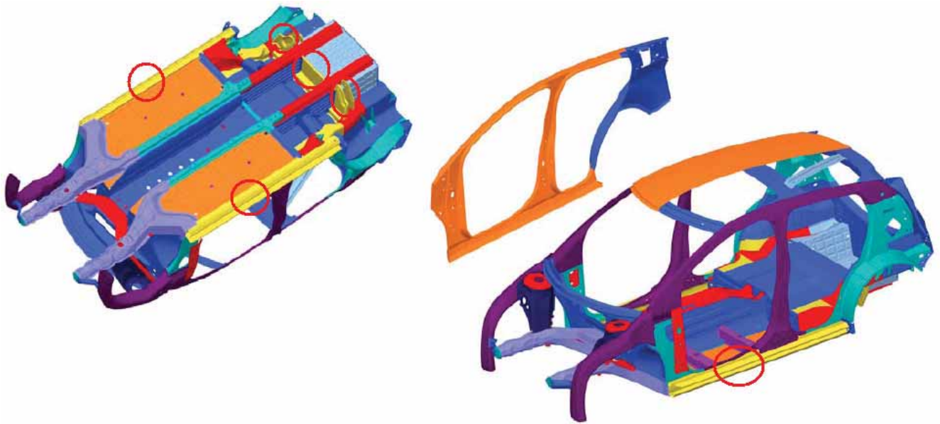
Figura 2.64 – Indicação de alguns componentes fabricados com aços de fases complexas, com destaque nas longarinas, que foram utilizados na concepção do modelo do projeto FSV (FUTURE STEEL VEHICLE – OVERVIEW REPORT, 2011).
