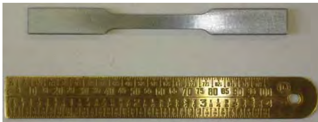
Figura 3.4 - Corpo-de-prova utilizado no ensaio de tração. (ASTM E 8M).
