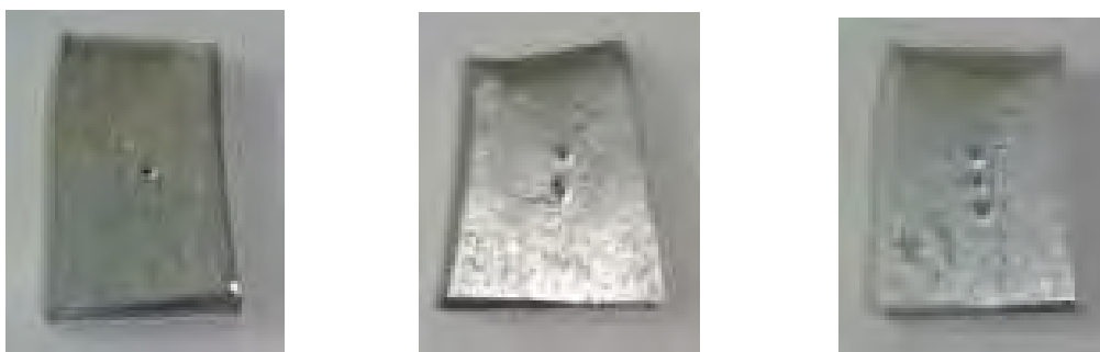
Figura 3.12 - Amostras referentes ao ensaio de fadiga axial, a partir dos corpos-de-prova rompidos em três níveis de tensão diferentes.
