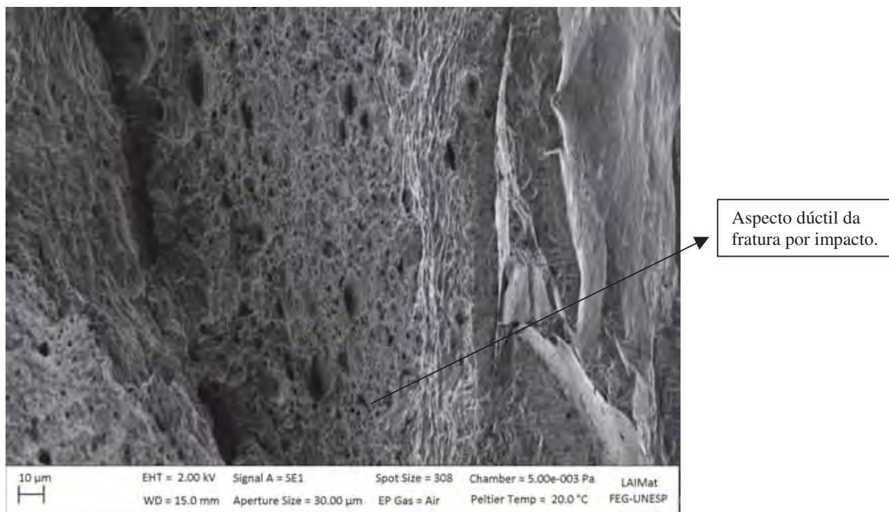
Figura 4.47 - Fratura para a faixa de temperaturas de 60°C, mostrando a zona de processo com aspecto dúctil. Aumento: 1.000X.
