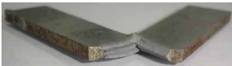
Figura 4.35 – Aspecto do corpo-de-prova após ensaio de impacto Charpy, tanto para a faixa de temperatura de -75^{\circ}\text{C} quanto para a de 60^{\circ}\text{C} .
