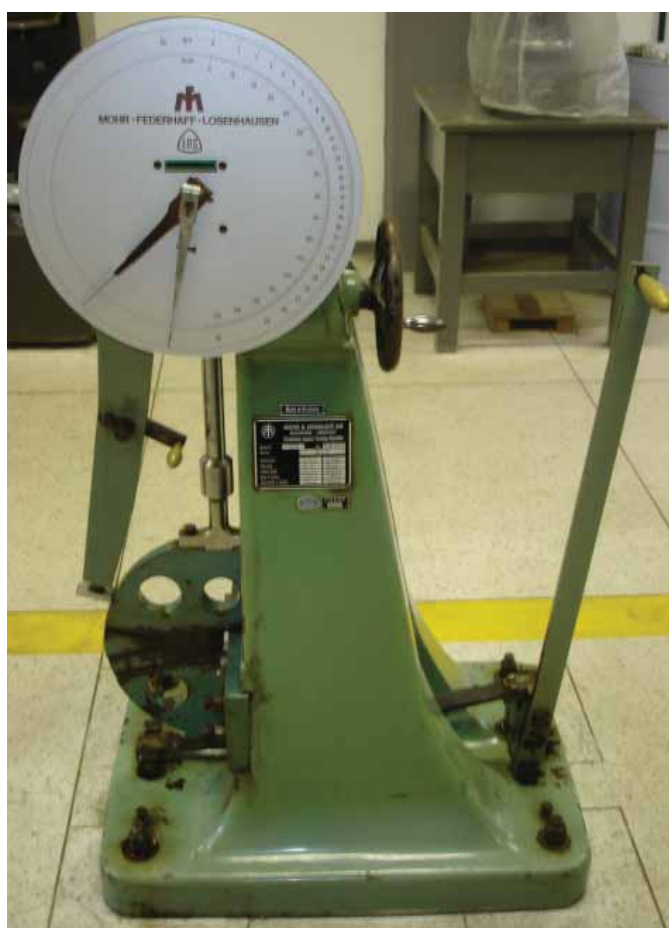
Figura 3.7 - Máquina de ensaio de impacto Charpy, modelo MOHR & FEDERHAFF AC - PWS 30/15. (UNESP – Campus de Guaratinguetá, 2011).
