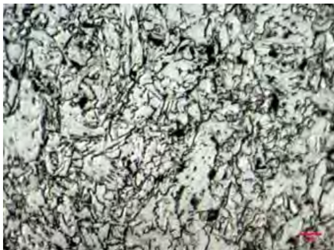
Figura 2.26 – Microestrutura de uma aço de fases complexas, laminado a quente (CPW-800) submetido a ataque químico com reagente Nital 2% e ampliação de 1.000X (PEREIRA, 2009).
