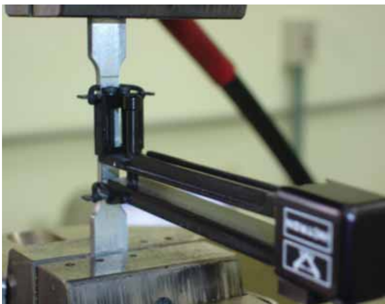
Figura 3.2 – Utilização de extensômetro durante a execução dos ensaios de tração dos corpos-de-prova na máquina INSTRON 8801. (UNESP – Campus de Guaratinguetá, 2011).
