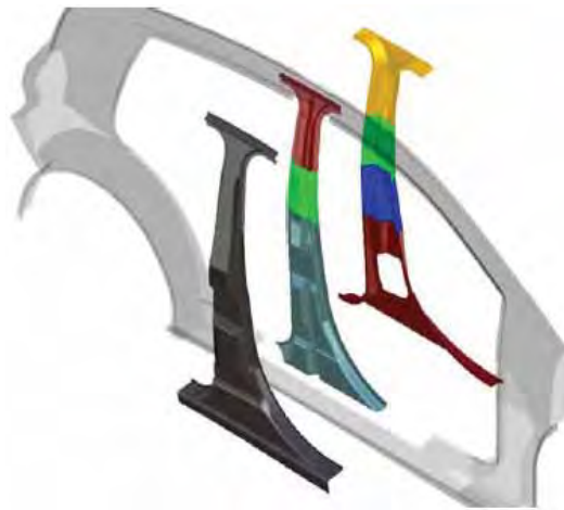
Figura 2.70 – Reforços da coluna B fabricados em aços de fases complexas e utilizados na concepção do modelo do projeto FSV (FUTURE STEEL VEHICLE – OVERVIEW REPORT, 2011).
