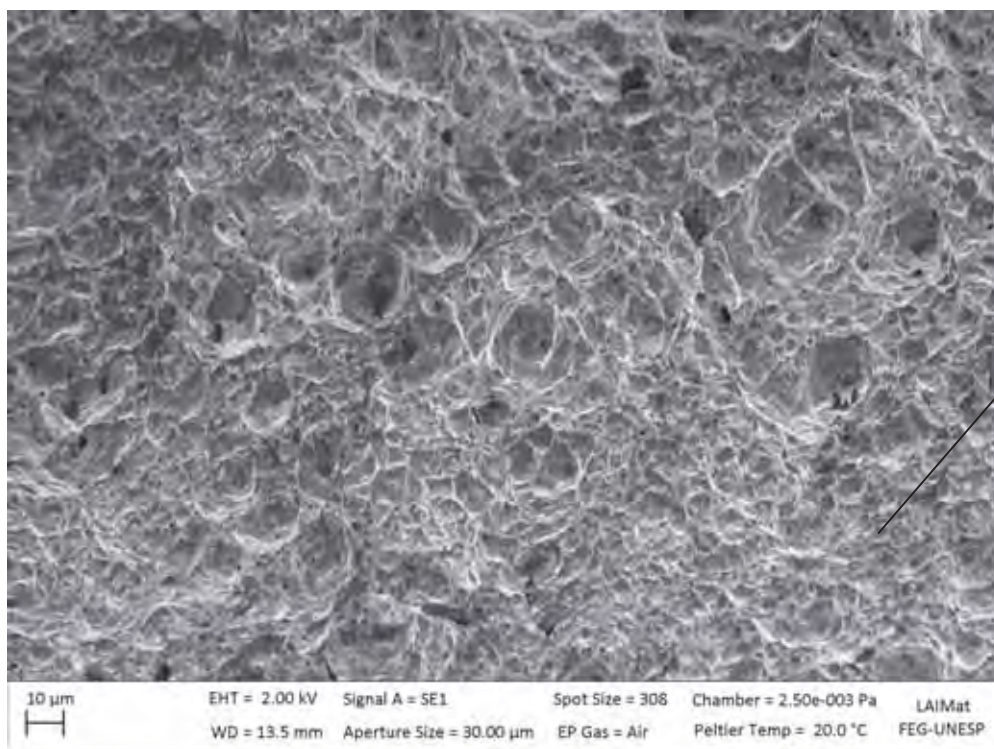
Figura 4.41 - Fratura para a faixa de temperaturas de -75^{\circ}\text{C} , mostrando região central do corpo-de-prova com dimples rasos e aspecto dúctil. Aumento: 1.000X
