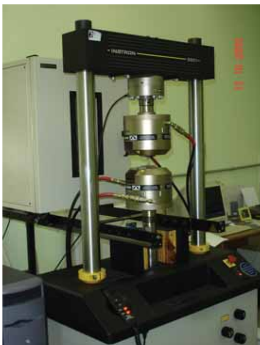
Figura 3.1 – Máquina INSTRON 8801 utilizada nos ensaios de tração. (UNESP – Campus de Guaratinguetá, 2011).
