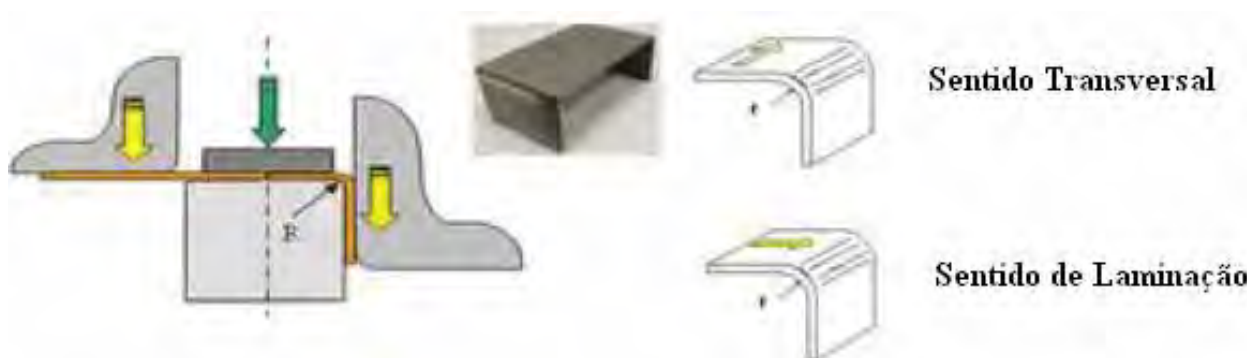
Figura 2.34 – Esquema do ensaio de dobramento, ao qual os aços de fases complexas foram submetidos. (ARCELORMITTAL, 2010)
