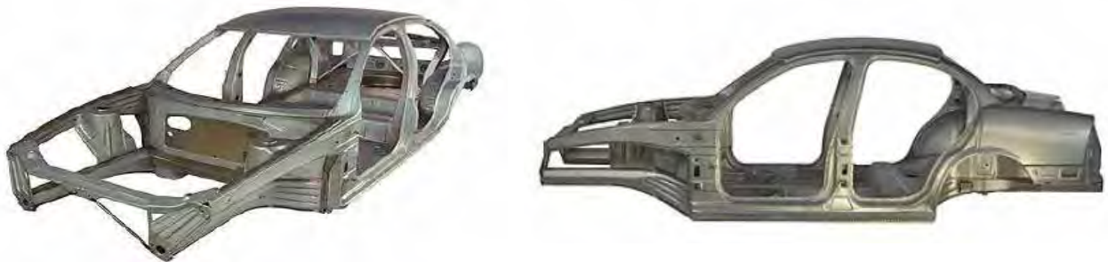
Figura 2.2 – Estrutura desenvolvida pelo projeto ULSAB, vista frontal e vista lateral. (ULSAB OVERVIEW REPORT – PHASE 2, 1998)
