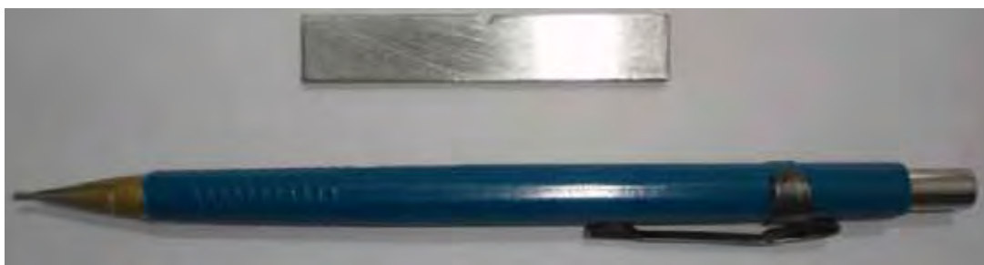
Figura 3.9 - Corpo-de-prova utilizado no ensaio de impacto (ASTM E 23).
