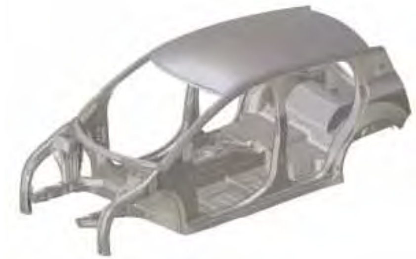
Figura 1.2 – Estrutura desenvolvida pelo projeto FutureSteelVehicle (FSV) produzida com aços avançados de alta resistência. (FUTURE STEEL VEHICLE OVERVIEW REPORT, 2011)
