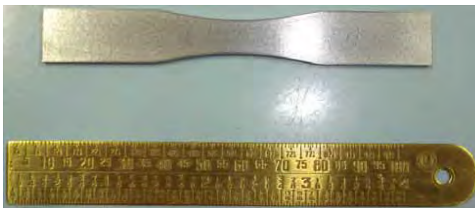
Figura 3.6 - Corpo-de-prova utilizado no ensaio de fadiga axial. (ASTM E 466).
