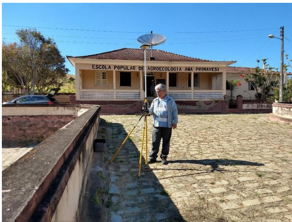
Figura 25 – Implantação de Vértice Geodésico
