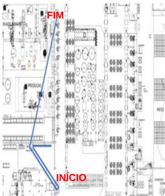
Figura 10 - Trajeto percorrido pelo operador da área de produção de tintas, executando o procedimento para produção de Isocianato, depois da modificação de layout.
