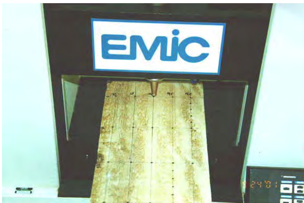
Figura 26 – Máquina universal de ensaios EMIC DL 10000 MF para ensaio de dureza normal às fibras em segmentos dos dormentes
