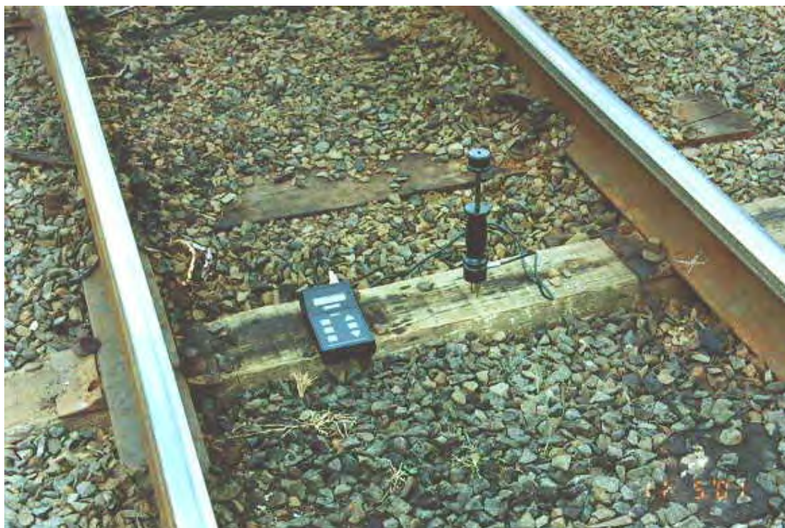
Figura 18 – Medição de umidade a campo
