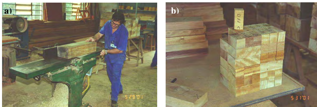
Figura 20 – Retirada dos corpos-de-prova — em processamento (a) e processados (b).
