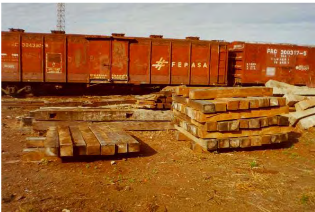
Figura 17 - Dormentes de madeira nativa, estocados no pátio de manobras na cidade de Botucatu – SP.
