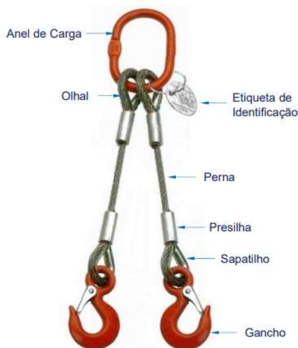
Figura 11 - Linga de duas pernas formada por elo de ligação, ganchos e pernas de cabo de aço com olhais, sapatilha e presilha.
