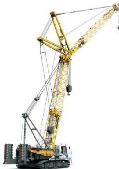
Figura 4 – Guindaste sobre esteiras Crawler Crane.
