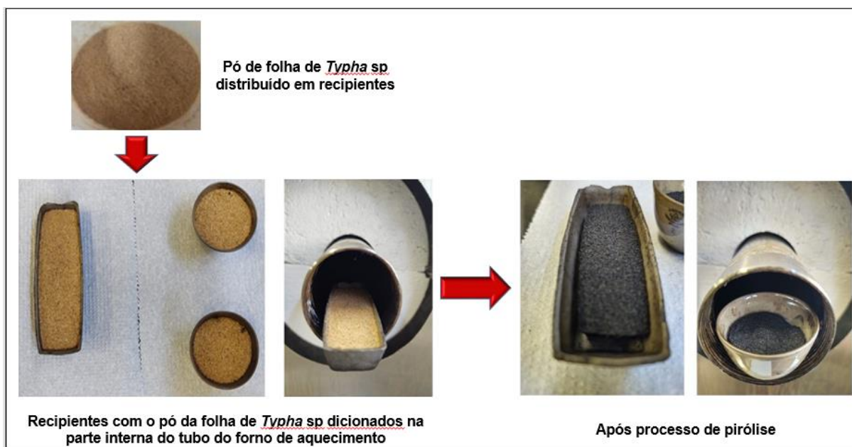
Figura 10. Pó do material de folha de Typha sp distribuído em barcas e cadinhos, os quais foram adicionados no interior do tubo metálico do forno de aquecimento.
