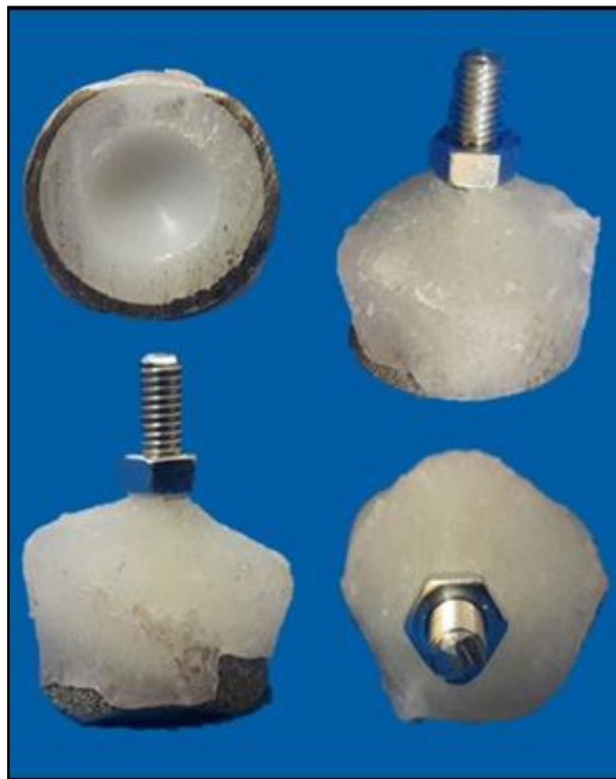
Figura 14. Imagem fotográfica da cúpula acetabular (28 mm) adaptada. Empregou-se o polimetilmetacrilato na superfície convexa do implante acetabular, a fim de inserir um parafuso sextavado de roscas finas sobre o seu vértice.
