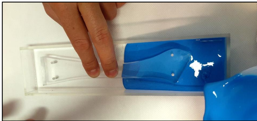
Figura 8. Imagem fotográfica mostrando o momento em que o silicone azul foi vertido na caixa acrílica. Observar o modelo de fêmur acrílico devidamente posicionado em seu interior.
