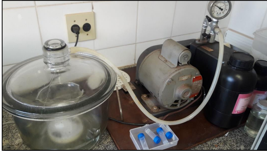
Figura 10. Imagem fotográfica do recipiente contendo resina fotoelástica na câmara de vácuo para eliminação de pequenas bolhas resultantes da reação inicial entre os componentes.
