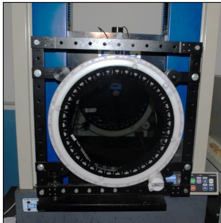
Figura 13. Imagem fotográfica do polariscópio de transmissão plana modelo FL200 do Laboratório de Bioengenharia da Faculdade de Medicina de Ribeirão Preto-USP, utilizado para realização das análises fotoelásticas.
