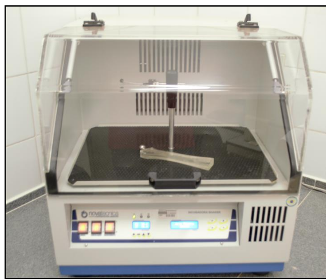
Figura 16. Imagem fotográfica mostrando o modelo fotoelástico no interior da estufa durante o processo de eliminação de tensão residual.
