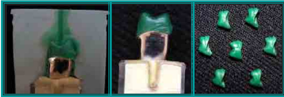
FIGURA 9 – Padrões de cera escultura Galileo. A primeira imagem é referente à cera no interior da matriz, sem a remoção dos excessos; a segunda imagem, ao padrão sobre o troquel; e a terceira imagem apresenta os padrões prontos para serem incluídos.
