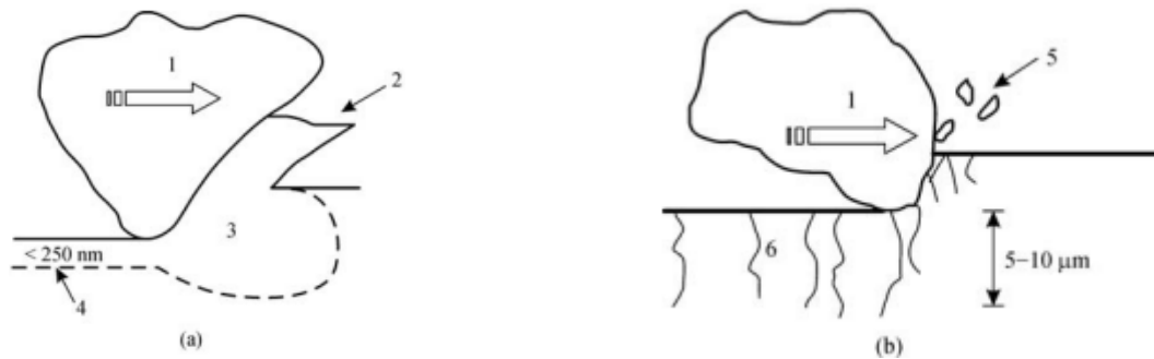
Figura 3 - (a) modo dúctil: 1 abrasivo (direção e sentido), 2 cavaco modo dúctil, 3 região plástica, 4 espessura removida. (b) 1 abrasivo (direção e sentido), 5 cavaco modo frágil, 6 microtrincas, 5 a 10 μm profundidade dos danos subsuperficiais.
