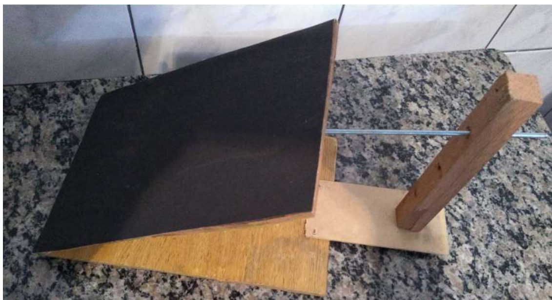
Figura 24 - Rampa com superfície áspera
