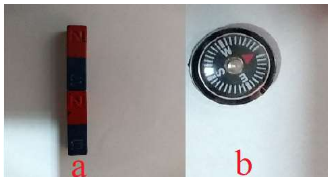
Figura 35 - a) ímãs com polos identificados; (b) bússola
