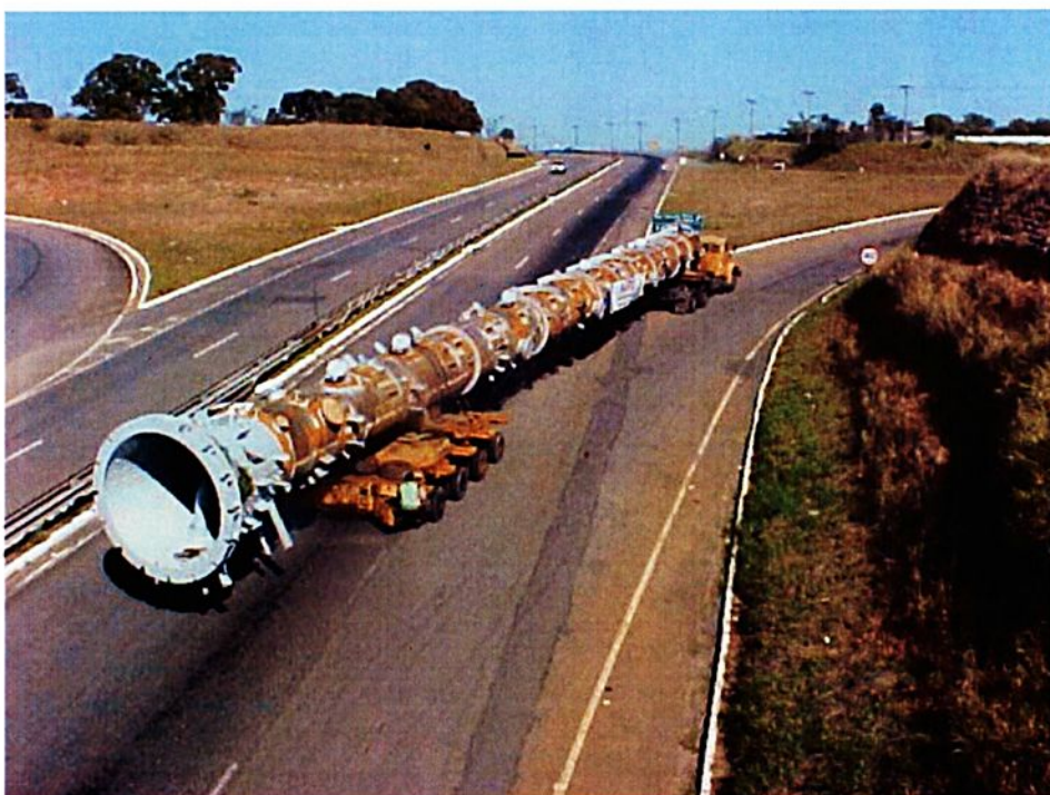
Figura 2.14 – Transporte de torre de processo (Ref.: arquivo Alstom Brasil Ltda)
