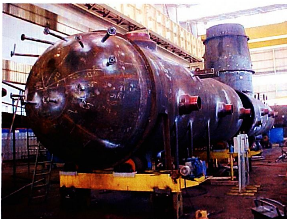
Figura 2.11 – Fabricação de vaso de pressão \varnothing interno = 2600 mm (Ref.: arquivo Alstom Brasil Ltda)
