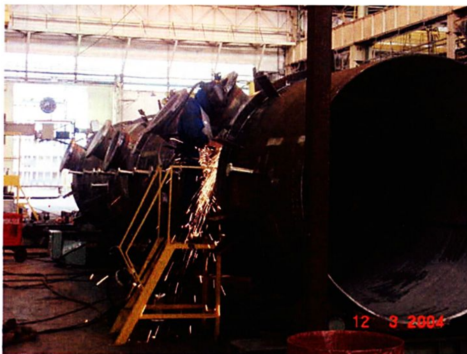
Figura 2.10 – Fabricação de vaso de pressão \varnothing interno = 2300 mm (Ref.: arquivo Alstom Brasil Ltda)
