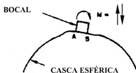
Figura 5.3 – Carga momento (M) aplicada em casca esférica
