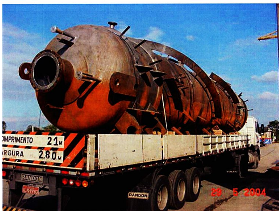
Figura 2.13 – Transporte de parte de vaso de pressão (trecho superior) (Ref.: arquivo Alstom Brasil Ltda)
