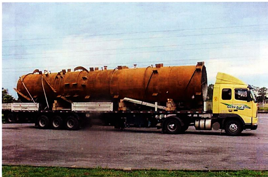
Figura 2.12 – Transporte de parte de vaso de pressão (trecho intermediário) (Ref.: arquivo Alstom Brasil Ltda)
