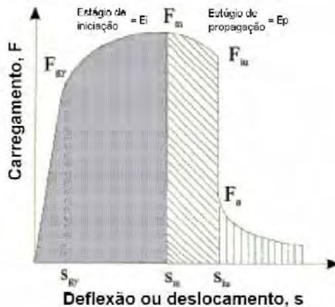
Figura 6 – Curva Força vs Deslocamento durante um ensaio de impacto Charpy instrumentado. (Fonte Fernandez et. al. 2002)
