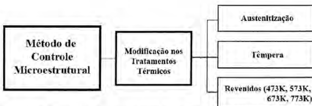
Figura 17 – Métodos de controle microestrutural utilizados nos corpos-de-prova, para melhorar a tenacidade à fratura do material
