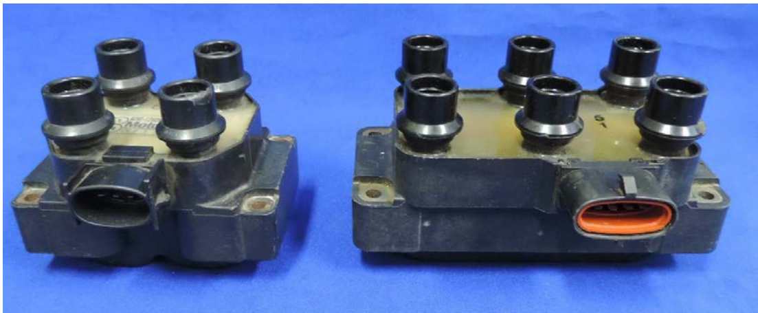
Figura 26 - Bobina de ignição saída dupla - motor 4 e 6 cilindros.
