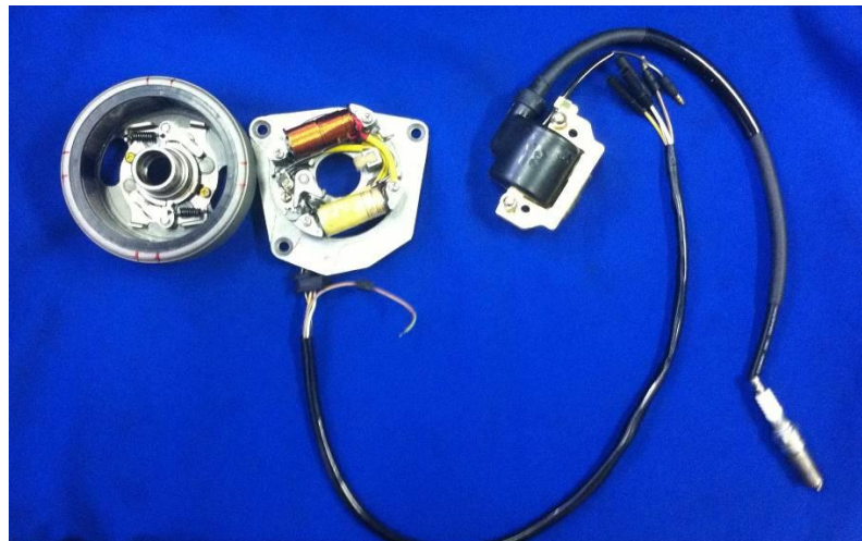
Figura 18 - Foto de sistema ignição - imã rotativo - magneto baixa tensão.
