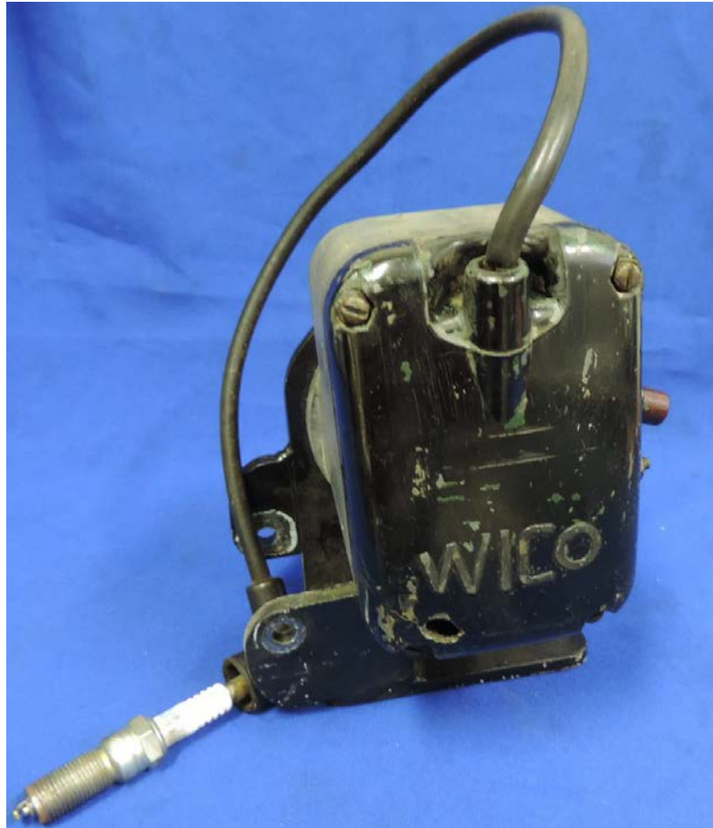
Figura 10 - Foto de magneto de alta tensão - monocilindro.
