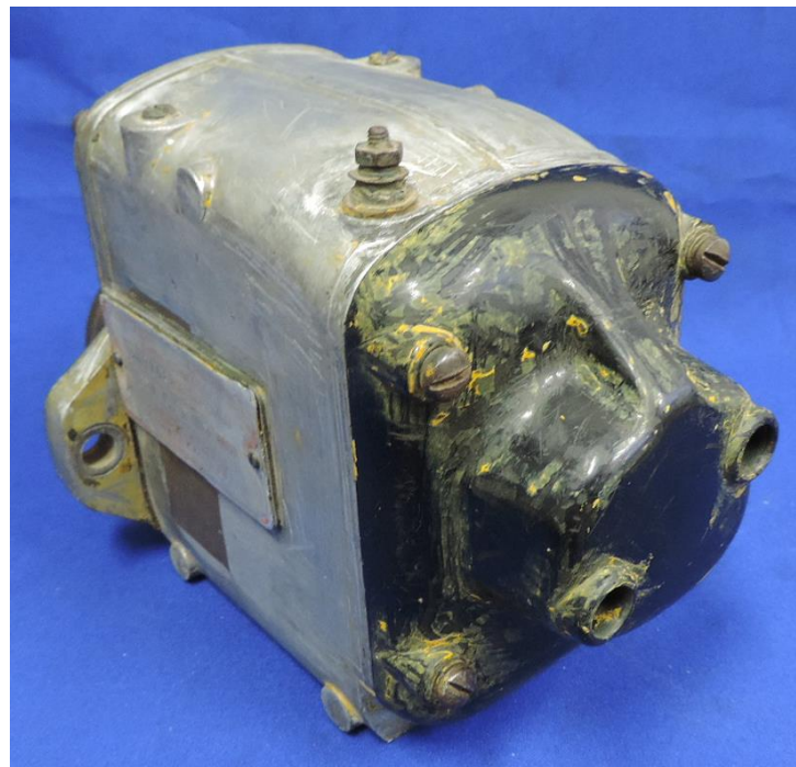
Figura 12 - Foto de magneto de alta tensão - motor dois cilindros.
