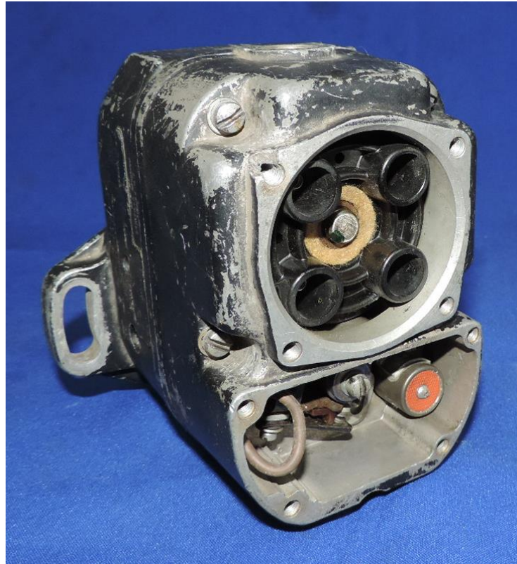
Figura 13 - Foto de magneto de alta tensão - motor quatro cilindros.
