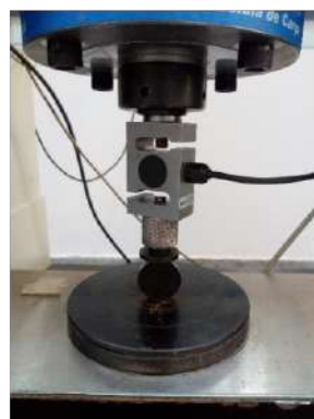
Figura 9 - Determinação da resistência à tração por compressão diametral de corpos de prova cilíndricos
