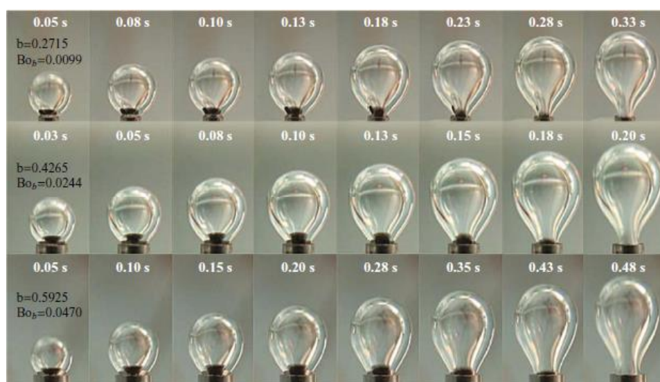
Figura 34 – Crescimento observado de uma bolha de gás injetado em meio líquido
