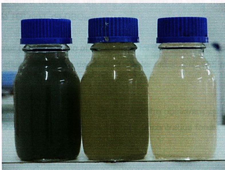
FIGURA 29: Foto dos Efluentes do sistema. Da esquerda para direita: Efluente bruto, do reator UASB e Biofiltro Aerado.
