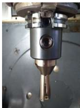
Figura 23 - Conjunto spindle , suporte e broca
