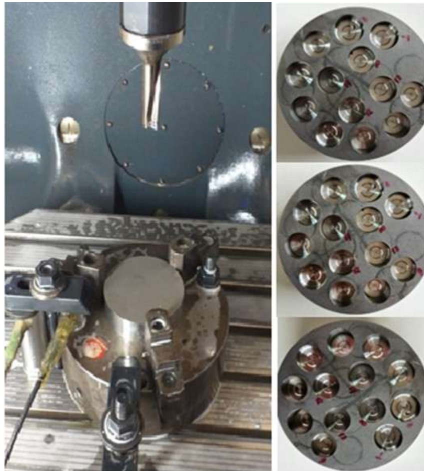
Figura 27 - Montagem do sistema de ensaios ilustrando corpo de prova cilíndrico preso por placa com castanhas e sensores de vibração e emissão acústica.
