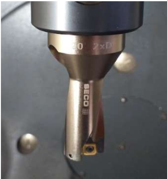
Figura 5 - Broca Com Inserto Intercambiável
