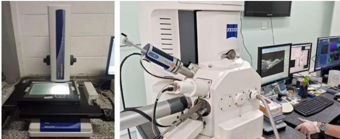
Figura 38 - Microscópio marca Mitutoyo modelo QS-LBZ -Visual QUICK SCOPE série 359 e Microscópio eletrônico de varredura ambiental Zeiss EVO LS-15, com EDS
