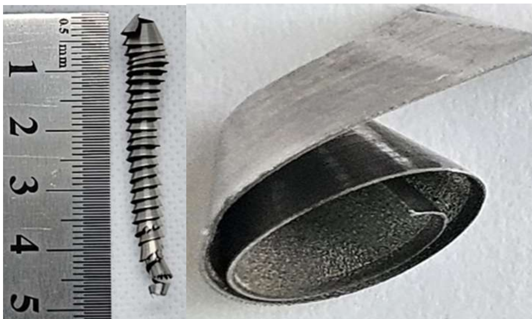
Figura 69 - Exemplo de cavacos cônico, longo, do tipo cisalhado (ensaio 2)
