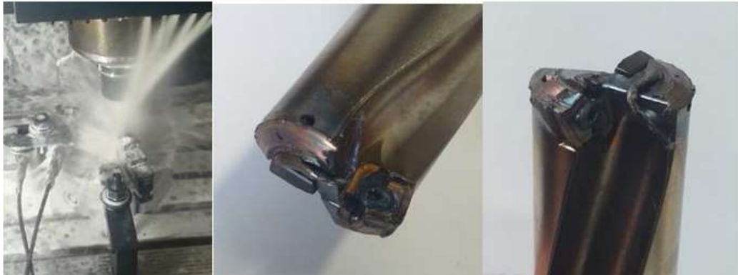
Figura 28 - Sistema de refrigeração atuando durante os ensaios e brocas fundidas durante e realização de ensaios preliminares.
