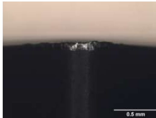
Figura 61 - Exemplo de formação de desgaste de flanco e aresta postiça de corte (APC) usando ferramenta \text{Ti(C,N)} + \text{Al}_2\text{O}_3 (ensaio 8)
