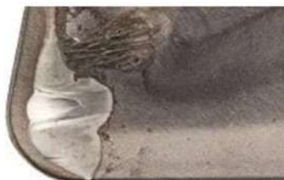
Figura 9 - Desgaste de Cratera
