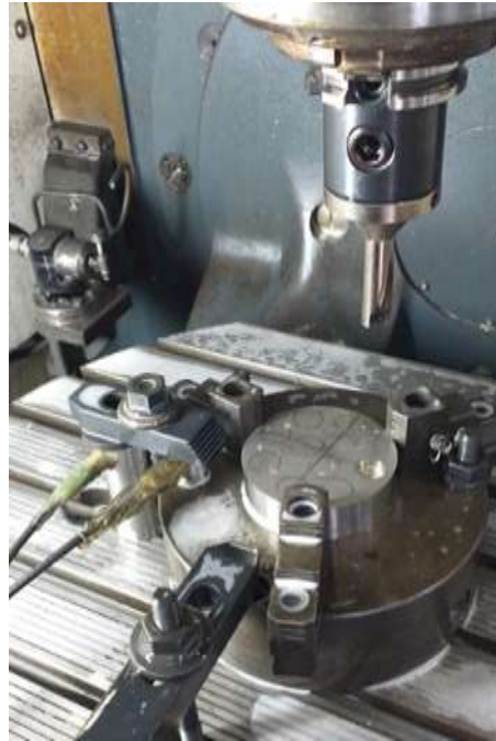
Figura 22 - Fixação dos corpos de prova através de placa com castanhas
