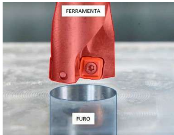
Figura 4 - Exemplo de Furação Helicoidal com Pastilhas Intercambiáveis
