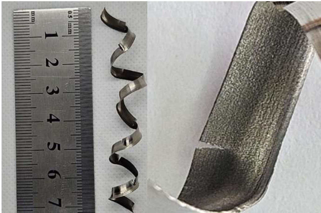
Figura 68 - Exemplo de cavacos em fita, emaranhado do tipo cisalhado (ensaio 1)
