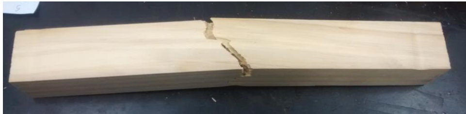
Figura 43: Corpo de prova de Pinus elliottii da ISO 13910:2005 com a ruptura na seção cisalhada
