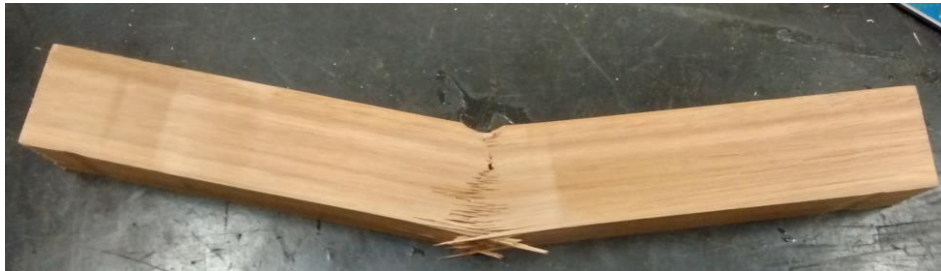
Figura 42: Corpo de prova de Eucalyptus saligna da ISO 13910:2005 com a ruptura na seção cisalhada
