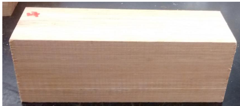
Figura 31: Corpo de prova para compressão paralela as fibras de acordo com a ABNT NBR 7190:1997
