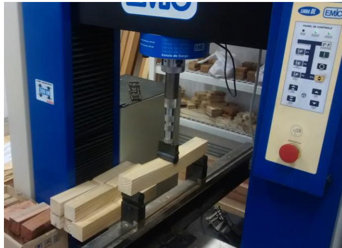
Figura 40: Ensaio dos corpos de prova de Pinus elliottii para cisalhamento paralelo às fibras segundo a ISO 13910:2005
