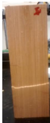
Figura 45: Corpo de prova da ABNT NBR 7190:1997 de compressão paralela as fibras com ruptura das fibras
