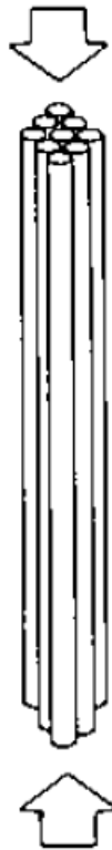
Figura 2: Feixe de canudos (analogia as células de madeira quando aplicado uma carga paralela as fibras ou traqueides)
