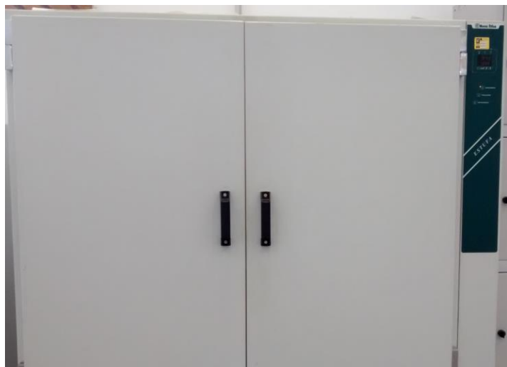
Figura 35: Estufa utilizada para a secagem dos corpos para a determinação do teor de umidade segundo a ABNT NBR 7190:1997
