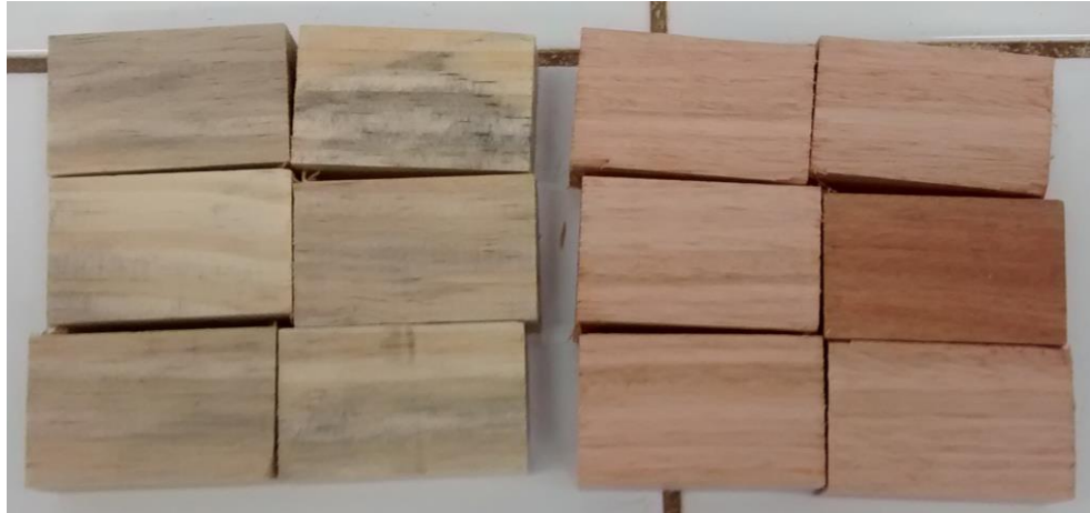
Figura 34: Corpos de prova de Pinus elliotii e Eucalyptus saligna para a determinação do teor de umidade de acordo com a ABNT NBR 7190:1997
