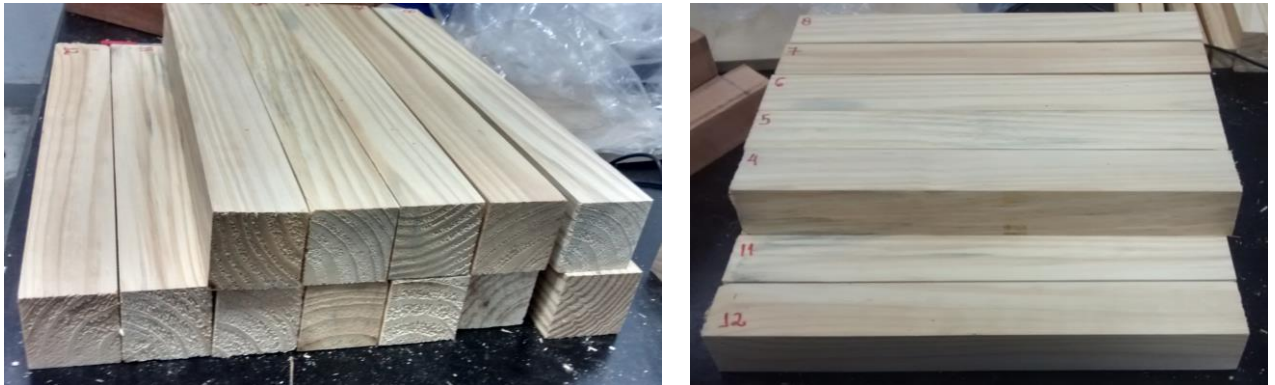
Figura 28: Corpos de prova de Pinus elliottii para cisalhamento paralelo as fibras de acordo com a ISO 13910:2005
