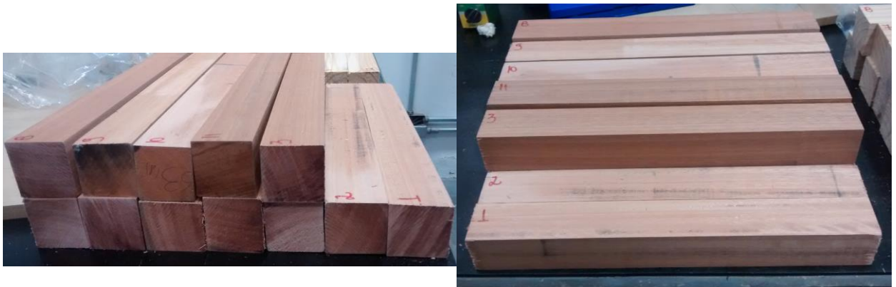
Figura 29: Corpos de prova de Eucalyptus saligna para cisalhamento paralelo as fibras de acordo com a ISO 13910:2005
