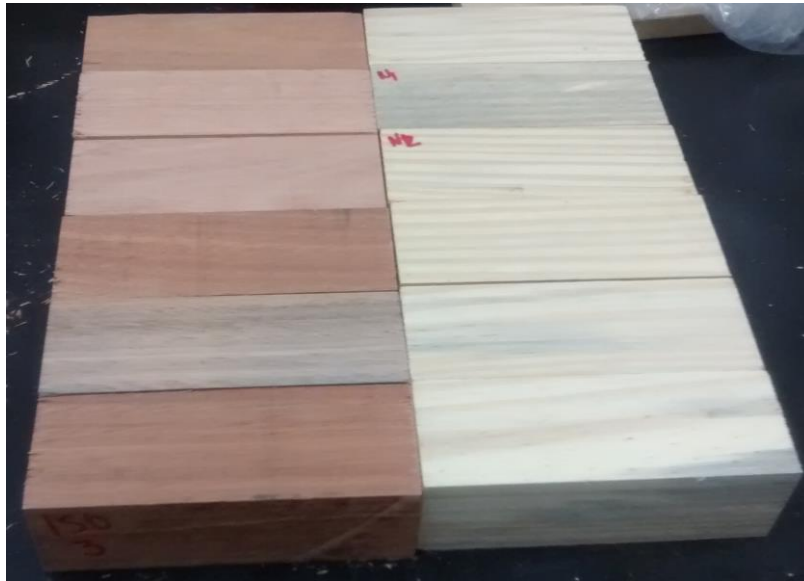
Figura 32: Corpos de prova de Pinus elliottii e Eucalyptus saligna para cisalhamento paralelo às fibras de acordo com a ABNT NBR 7190:1997
