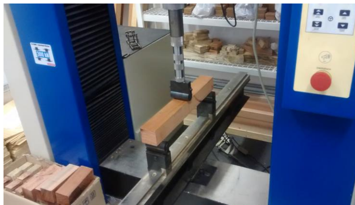
Figura 41: Ensaio dos corpos de prova de Eucalyptus saligna para cisalhamento paralelo às fibras segundo a ISO 13910:2005
