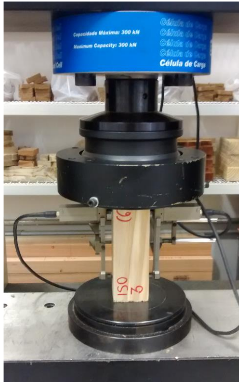
Figura 44: Corpo de prova no ensaio de compressão paralelo as fibras seguindo a ABNT NBR 7190:1997
