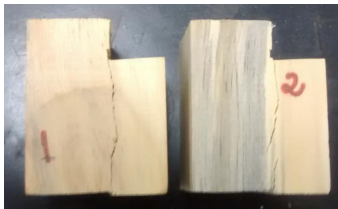
Figura 39: Corpos de prova com ruptura na seção de cisalhamento
