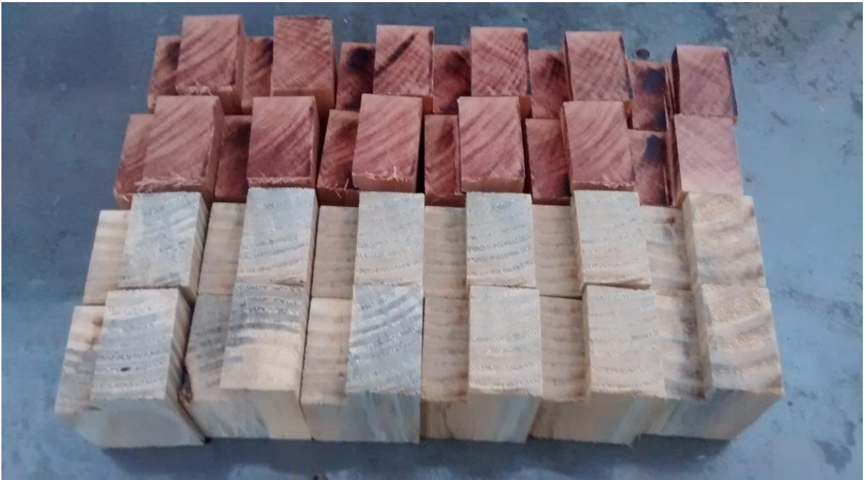
Figura 27: Corpos de prova confeccionados para cisalhamento paralelo as fibras de Pinus elliottii e Eucalyptus saligna seguindo a NBR 7190:1997
