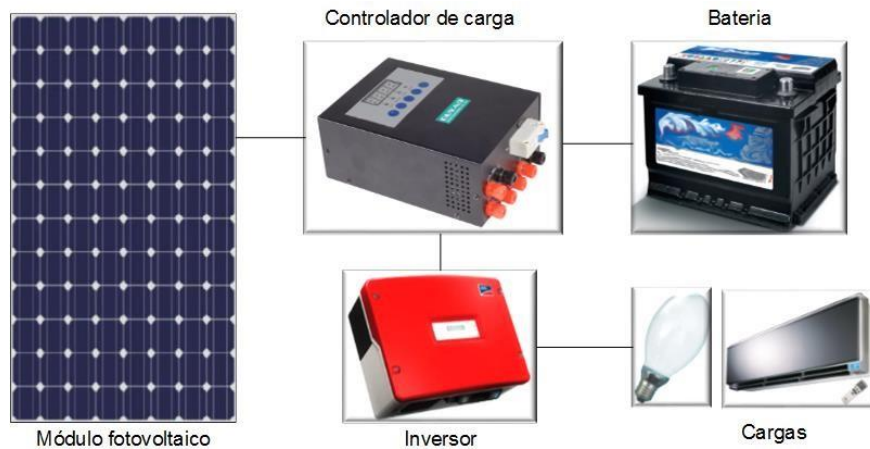
Figura 2 - Componentes de um sistema fotovoltaico autônomo
