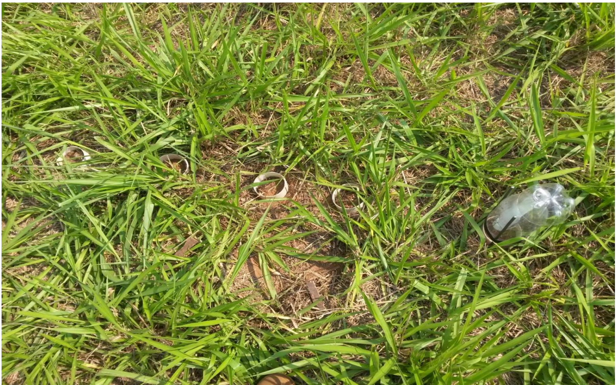
Foto 4 - Vista geral da campânula de coleta de amônia instalada e cilindros instalados para as próximas avaliações.
