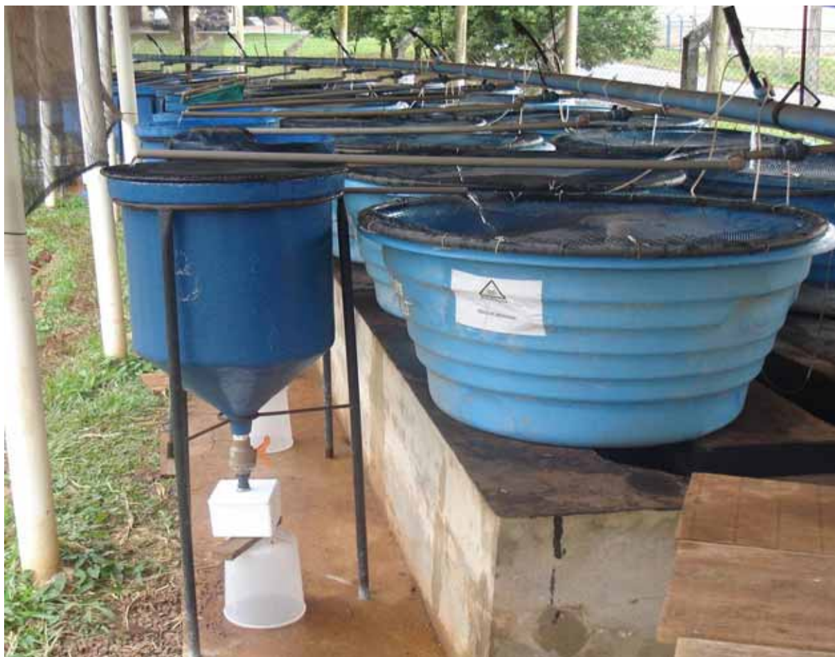
Figura 7. Incubadoras (80 L) adaptadas e dispostas ao lado das caixas experimentais (310 L) para coleta de fezes.
