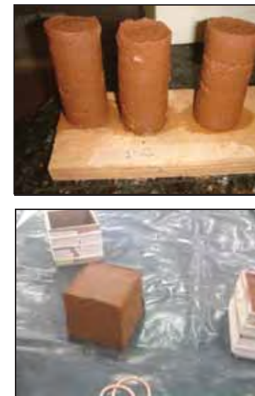
Figuras 8 e 9 – Corpos de prova cilíndricos e prismáticos Fonte: PASSALAUQUA; SOUZA; TOMAGAMI, p. 14, 2012
