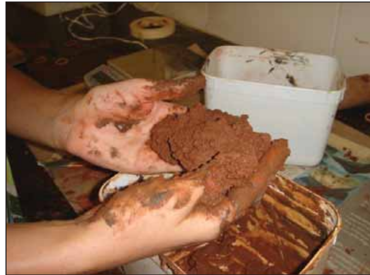
Figura 7 – Mistura de lodo com o solo de Presidente Prudente Fonte: PASSALAQUA; SOUZA; TOMAGAMI, p. 13, 2012
