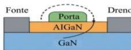
Figura 5: Representação esquemática do tunelamento direto em um transistor HEMT.
