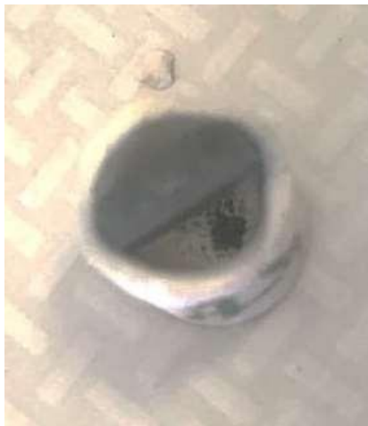
Figura 10 - Óxido descolado da amostra e no fundo do cadinho após o ensaio de 1000°C.
