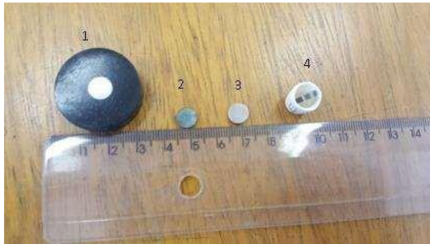
Figura 5 - Amostra lixada e polida para a caracterização microestrutural do material de partida (amostra 1), amostra antes do ensaio de oxidação (amostra 2), amostra após o ensaio de oxidação (amostra 3) e o conjunto cadinho + amostra utilizado para os ensaios de oxidação (amostra 4)
