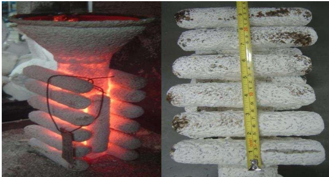
Figura 4 - Molde cerâmico antes (direita) e depois (antes) do vazamento do material
