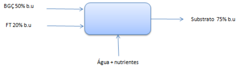
Figura 11: Balanço material do biorreator
