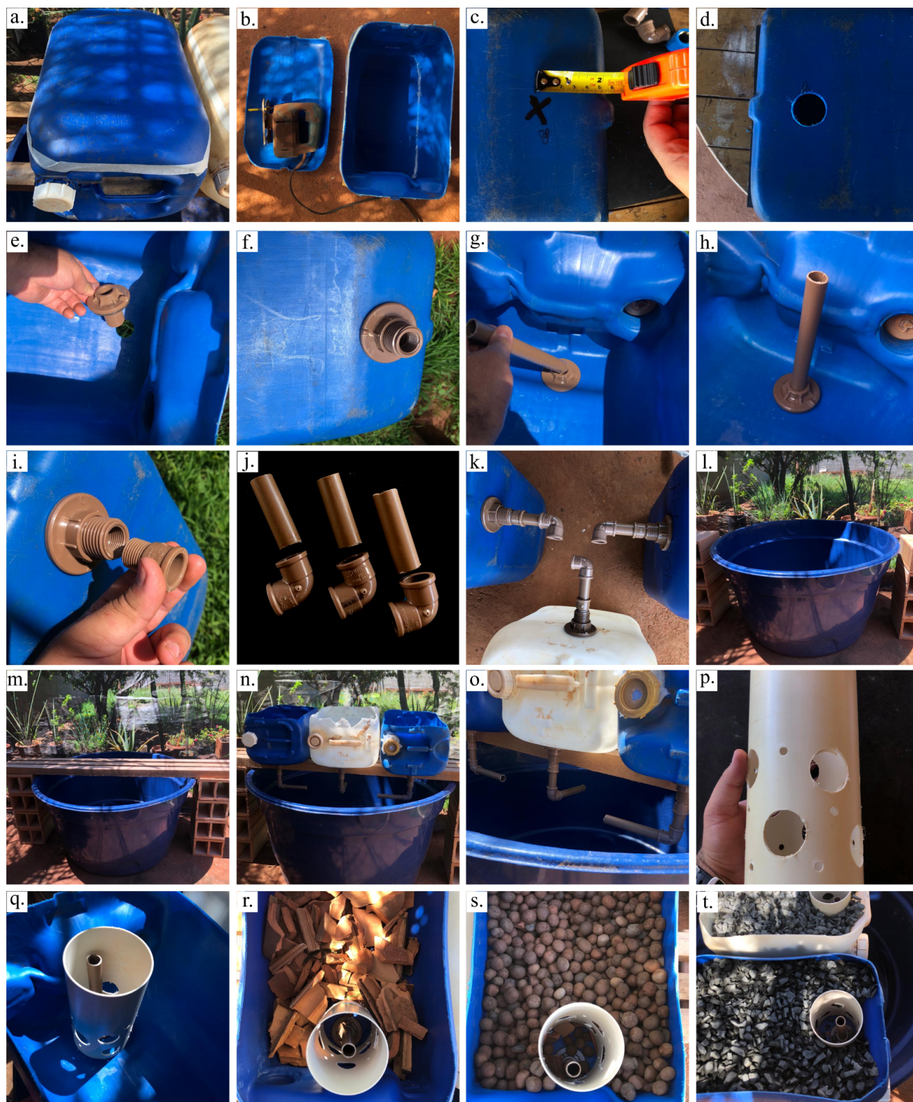
Figura 5. Etapas I à VIII da montagem do sistema aquapônico.
