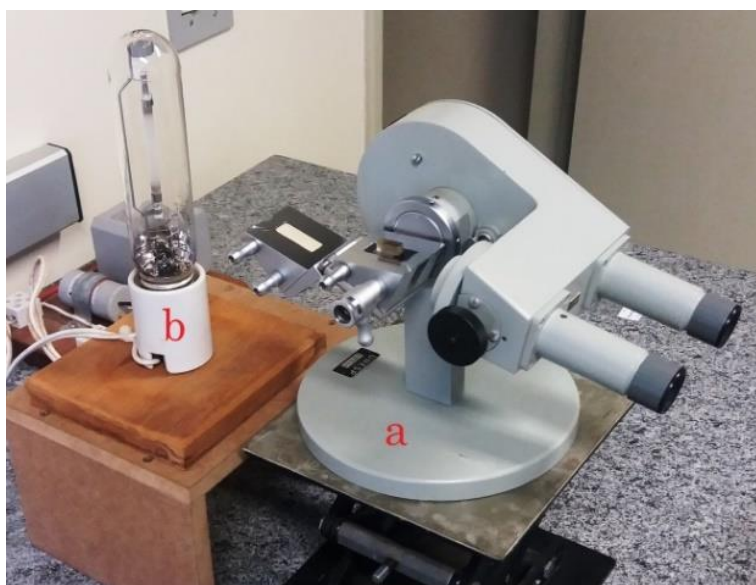
Figura 4: Arranjo experimental utilizado para medida do índice de refração: (a) Refratômetro Abbe, (b) lâmpada de vapor de sódio a alta pressão.
