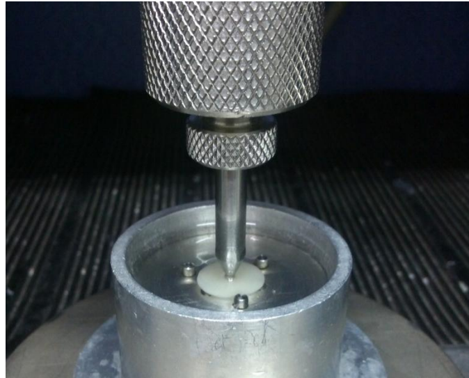
Figura 5 - Teste de flexão biaxial, espécime posicionado submerso em água.
