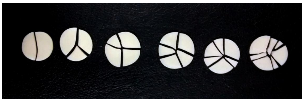
Figura 20- Imagem das fraturas dos discos com respectivamente 2 à 7 pedaços.
