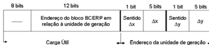
Figura 7.1: Composição do pacote que deve ser enviado à unidade de geração pelo bloco BCERP
