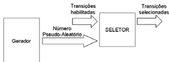
Figura 2.9: Diagrama de blocos do seletor Adaptada de (KUBÁTOVÁ, 2003a)
