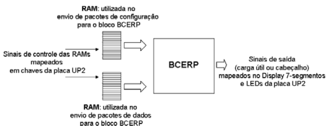
Figura 8.10: Sistema utilizado para o teste do bloco BCERP no FPGA
