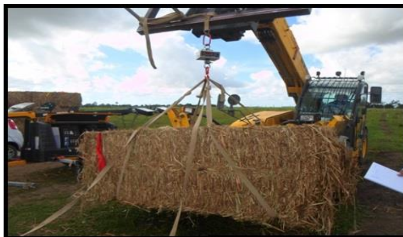
Figura 11. Pesagem dos fardos com o auxílio de uma balança digital.
