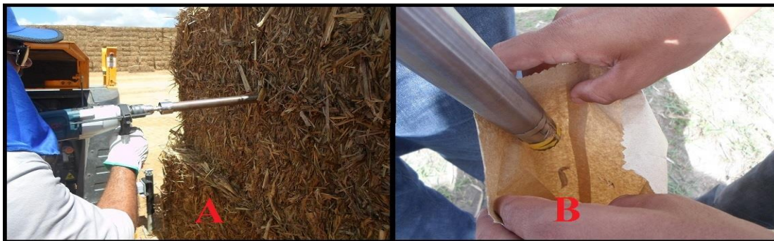
Figura 9. A – Amostragem dos fardos com o auxílio de uma sonda adaptada a uma furadeira. B – Separação do material coletado pela sonda, para posterior análise em laboratório.
