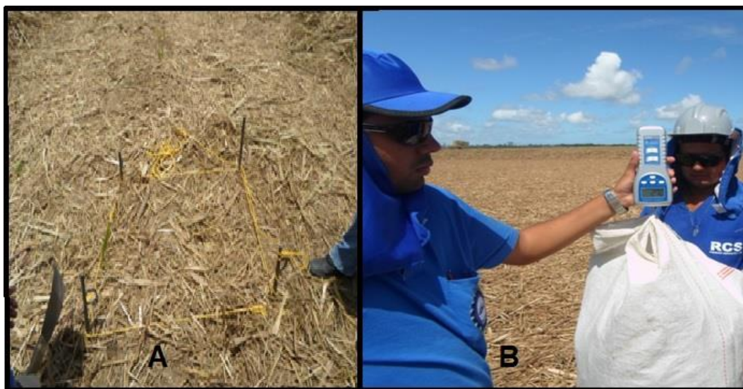
Figura 4. A= Área de amostragem ( 1\ m^2 ) do palhiço disponível no campo, antes da operação de aleiramento da palha; B = Pesagem da amostra coletada de palhiço utilizando balança digital.
