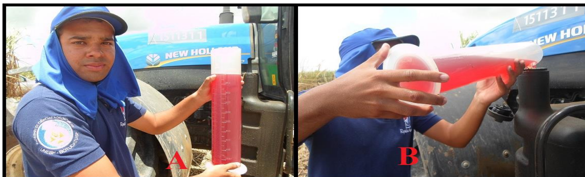
Figura 14. A – Ensaio de consumo de combustível, proveta graduada utilizada para abastecer o tanque de combustível dos tratores. B – Abastecimentos dos tanques de combustíveis dos tratores com diesel.
