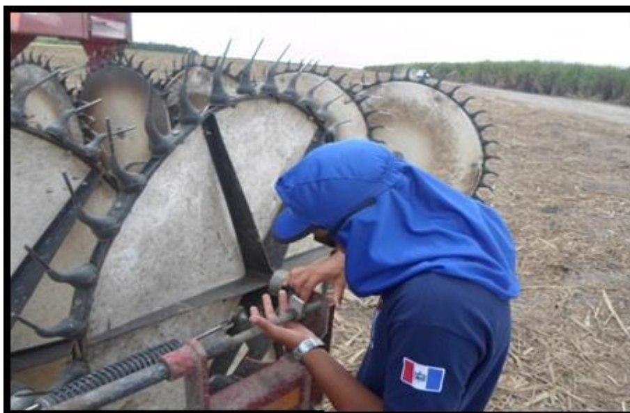
Figura 3. Regulagem do aleirador realizada para obter o volume de recolhimento do palhiço em cada tratamento.
