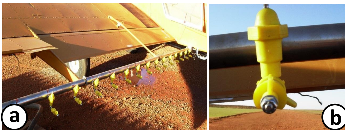
Figura 2. Pontas CP-03 utilizadas no ensaio, detalhe para a asa esquerda da aeronave com 14 pontas, em um total de 28 (a) e detalhe da ponta CP-03 com as regulagens das alavancas (b).
