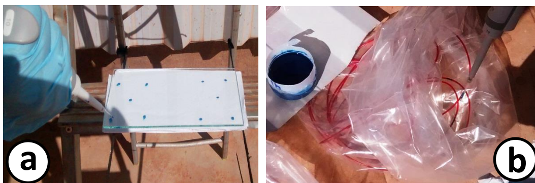
Figura 9. Imagens da avaliação da degradação e retenção em lâmina de vidro (a) e em fios de nylon (b).
