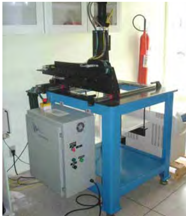
Figura 11 – Equipamento de inspeção por ultrassom utilizado na análise dos compósitos em estudo
