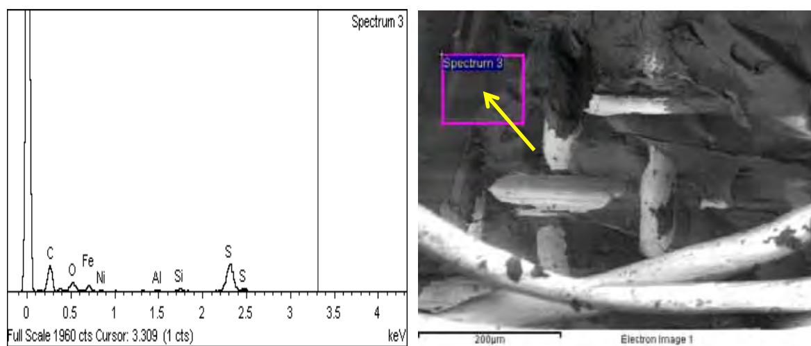
Figura 48 – Análise de EDS da superfície da amostra soldada de PPS/fibras de vidro
