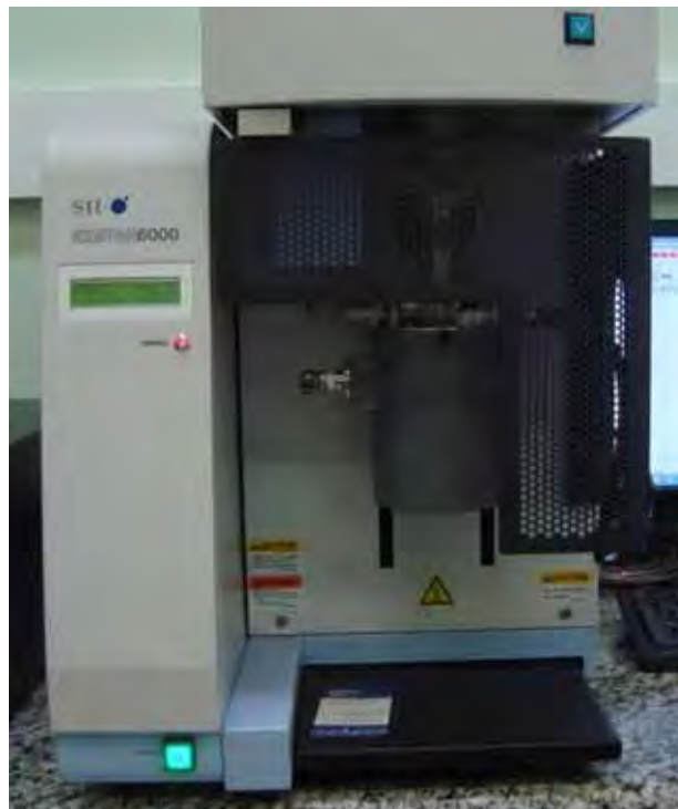
Figura 15 – Equipamento TMA utilizado para caracterização dos laminados em estudo
