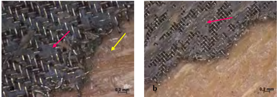
Figura 39 – Avaliação por estereoscopia da amostra de PPS/fibras de vidro soldada após o ensaio de lap shear : a) 20X; b) 10X
