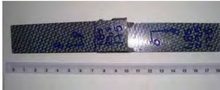
Figura 9 – Corpo de prova de PPS/fibras de carbono, após o ensaio de lap shear
